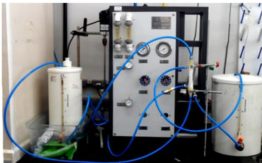
Figura 4.7 - Ilustração do sistema de remoção e recuperação de amônia utilizado com membranas contactoras
