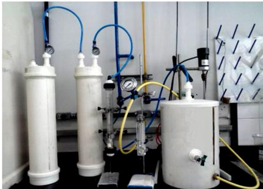
Figura 4.4 - Ilustração do sistema de air stripping associado a dois lavadores de gases para recuperação de amônia
