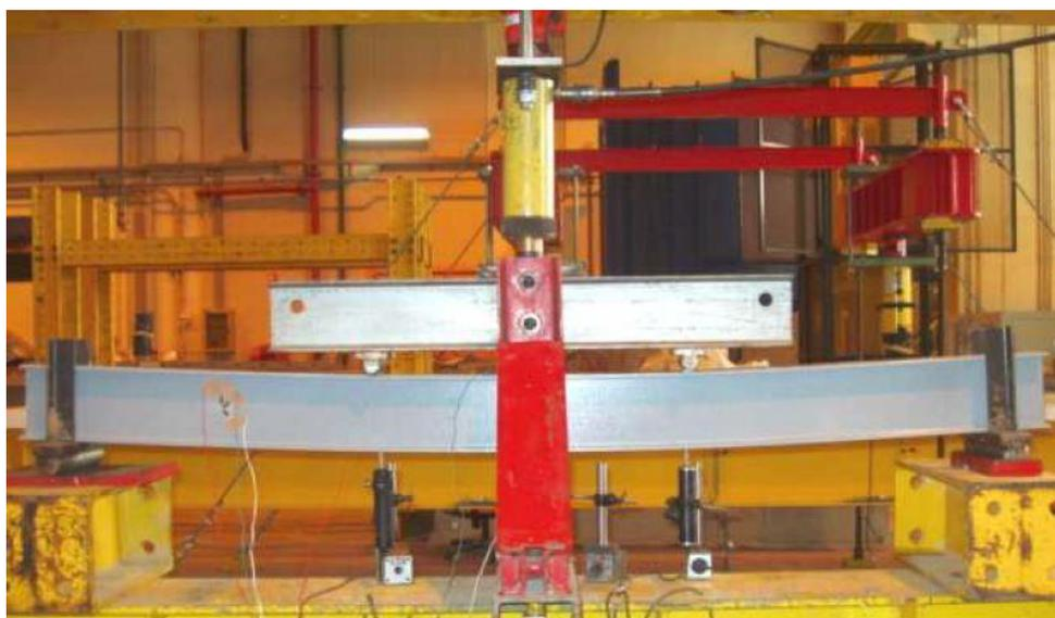
Figura 6-30: Perfil estrutural real submetido à fluência no ensaio de flexão de quatro pontos (Sá, 2007)
