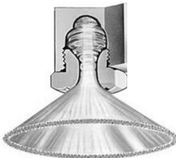
**FIGURA 2.7** – Spray cônico e oco (esquema)
