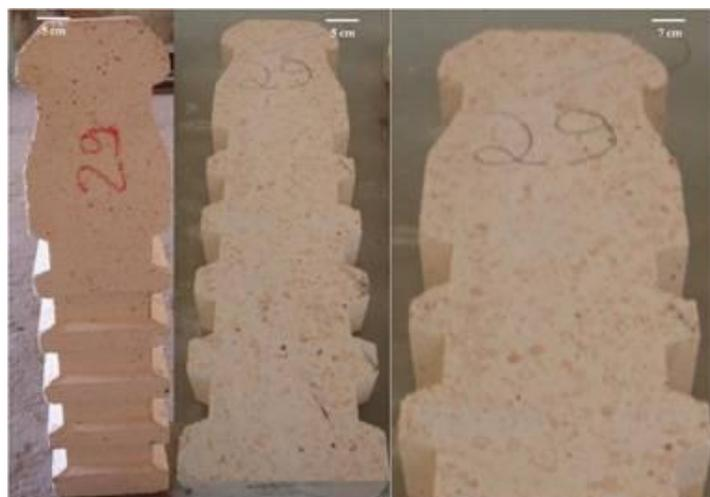
Figura 18 - Âncora de parede 29 sob suspeita com velocidade menor no ensaio de ultrassom.
