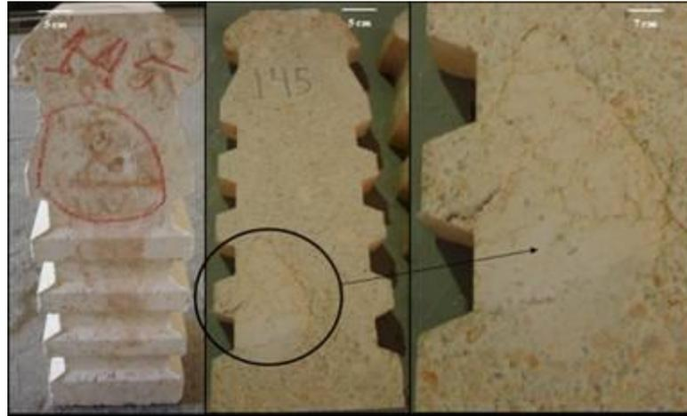
Figura 16 - Âncora de teto 145 sob suspeita com presença de grumos internos.
