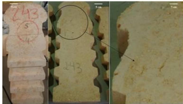
Figura 17 - Âncora de teto 243 sob suspeita com presença de trincas internas.
