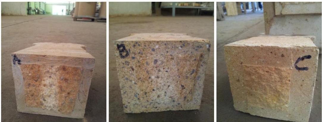
**Figura 28 – Estudo da estrutura e análise de trincas das peças usadas por corte transversal nas âncoras A e B (2 anos) e C (20 anos).**
