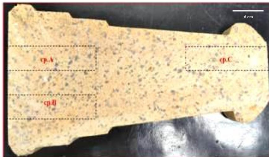
**Figura 11 – Regiões da retirada de corpos de prova da âncora cerâmica para o teste de resistência à flexão a quente a  $1200^\circ\text{C}$  x 60 min. (HMOR) [36].**
