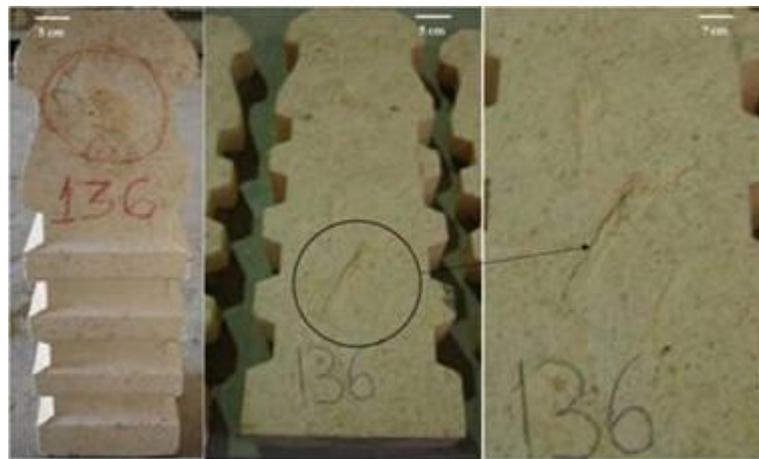
**Figura 15 - Âncora de teto 136 sob suspeita com presença de trincas internas.**
