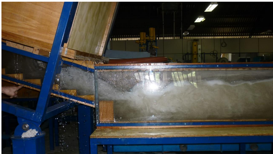
Figura 4.9 -Primeira passagem de água para verificação de pontos de vazamentos.
