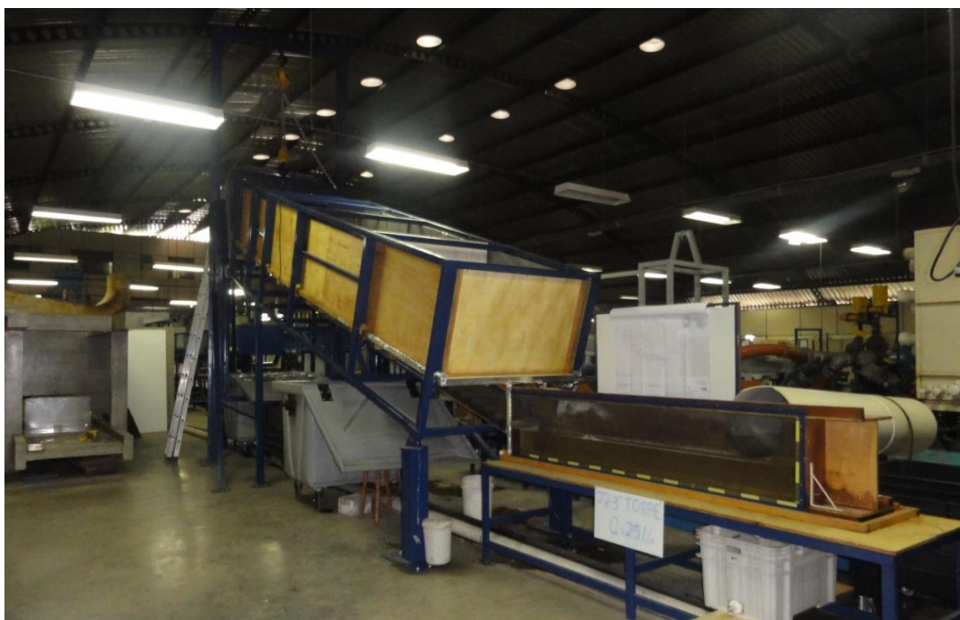
Figura 4.13 -Vista frontal do modelo hidráulico reduzido de sistema extravasor operacional da Barragem Forquilha IV.
