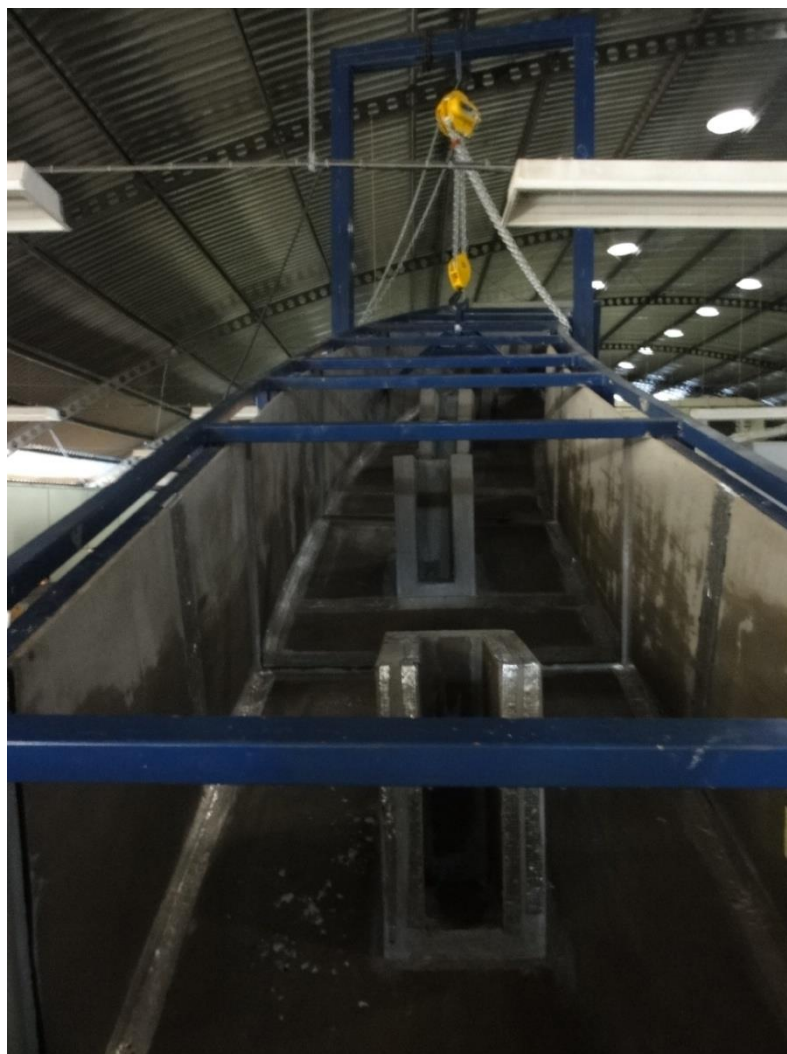
Figura 4.15 -Vista frontal das torres de tomada d'água do modelo hidráulico reduzido de sistema extravasor operacional da Barragem Forquilha IV.
