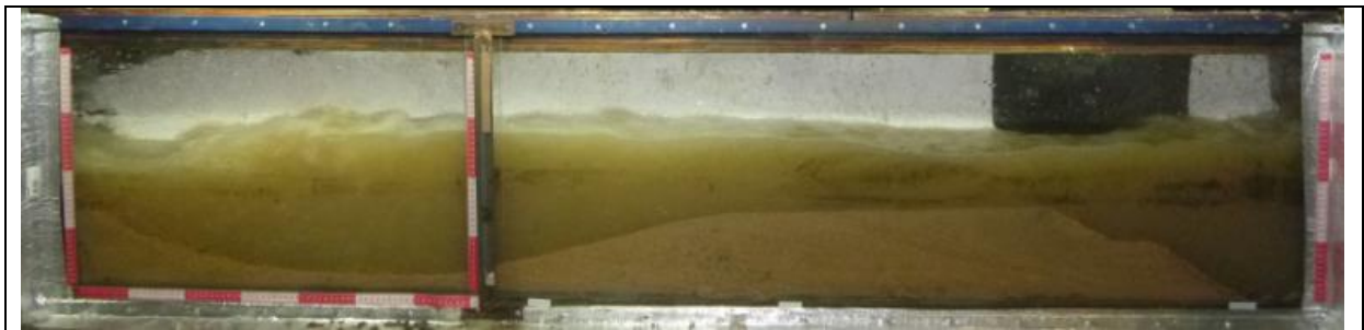
Figura 6.5 -Simulação do hidrograma superior ao decamilenar com a caixa de transição assoreada com brita 0 até a soleira do túnel.
