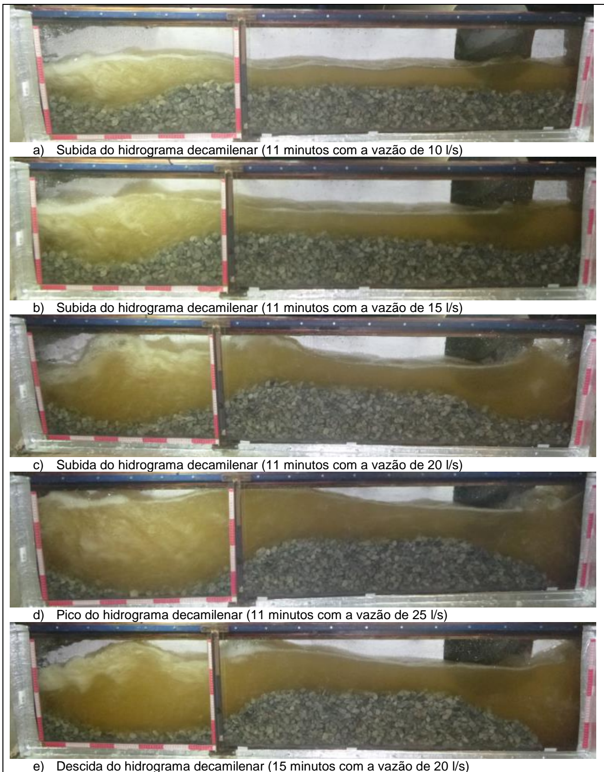
Figura 6.4 - Simulação do hidrograma decamilenar com a caixa de transição assoreada com brita 1 até a soleira do túnel. (Continuação)
