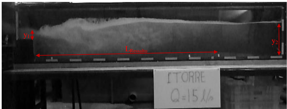
Figura 5.5 -Caixa de transição -situação de entrada do escoamento pela lateral da Torre 1 para uma vazão de 15 l/s.
