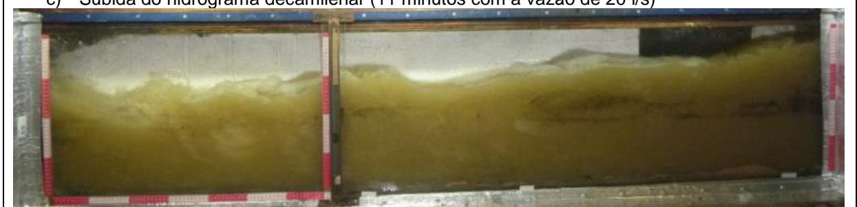
Figura 6.6 -Simulação do hidrograma decamilenar com a caixa de transição assoreada com areia até a soleira do túnel.
