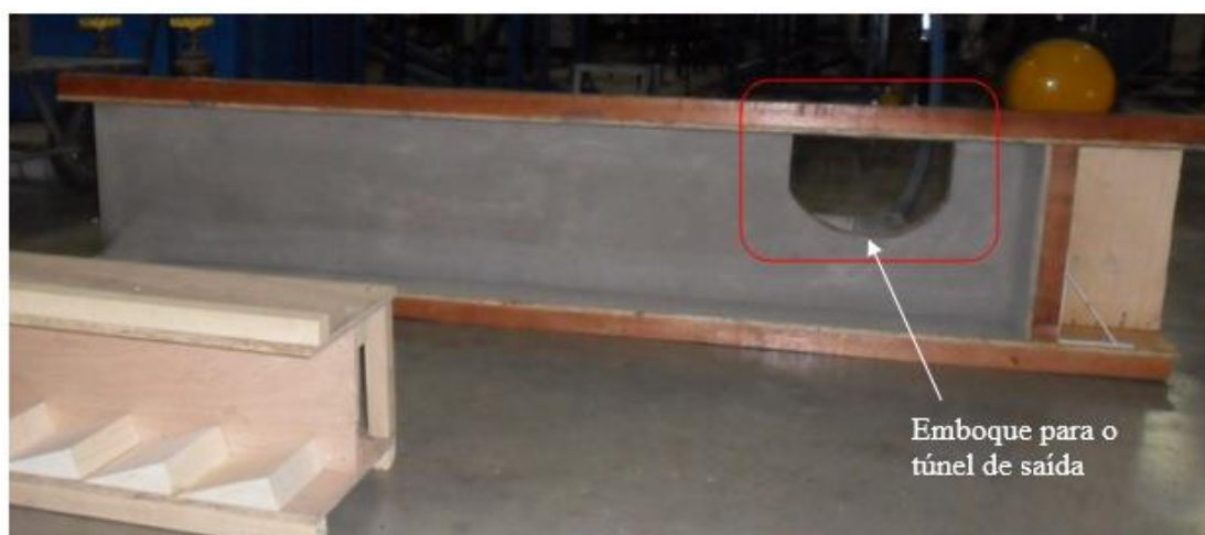
Figura 4.12 -Vista da caixa de transição já com a implantação do emboque do túnel de saída – fase de construção.
