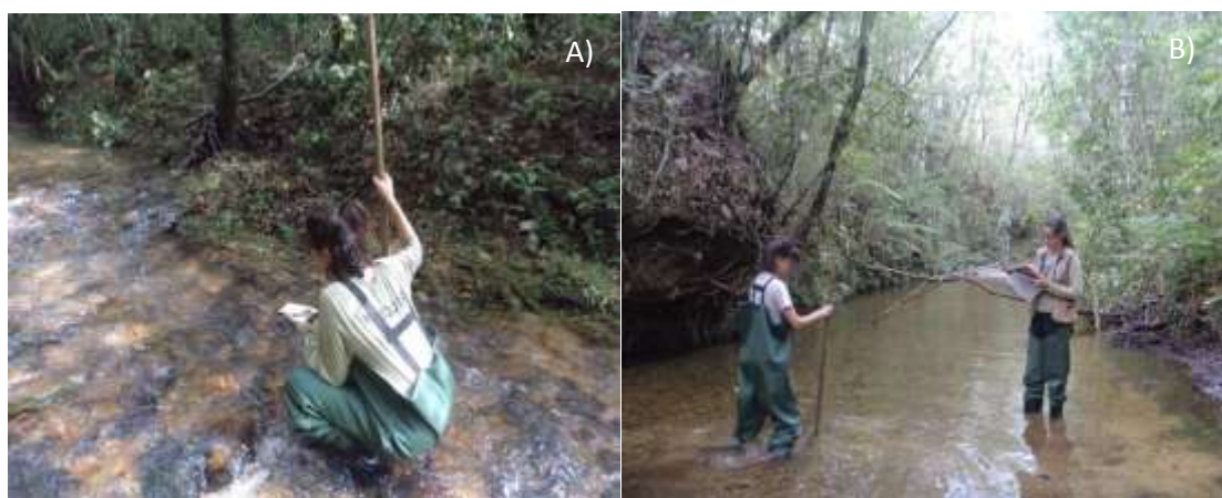
Figura 5 – Aplicação do protocolo de avaliação de habitats físicos em riachos de cabeceira na bacia do rio Araguari, MG. A) Verificação da densidade de cobertura vegetal; B) Medição de profundidade.
