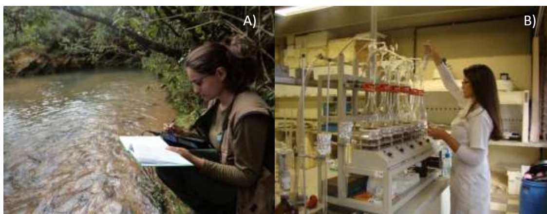
Figura 6 - Mensuração in situ de parâmetros físicos na água (A) e análises de parâmetros químicos em laboratório (B).
