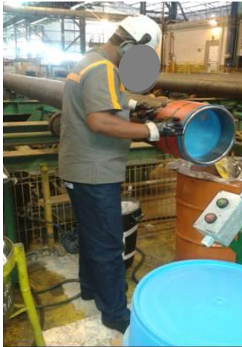
Figura 23 – Uso de esmeril para retirada de defeito.
