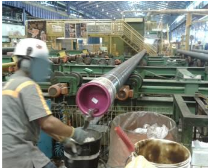
Figura 22 – Uso da chave para apertar protetor.
