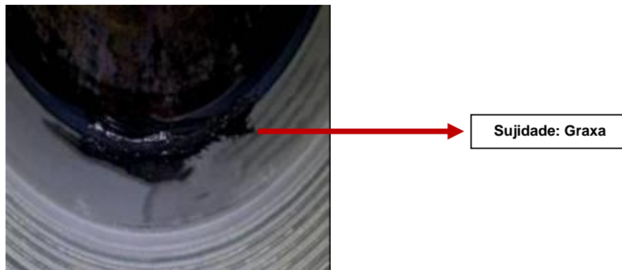
Figura 09 – Sujidade em rosca interna.
