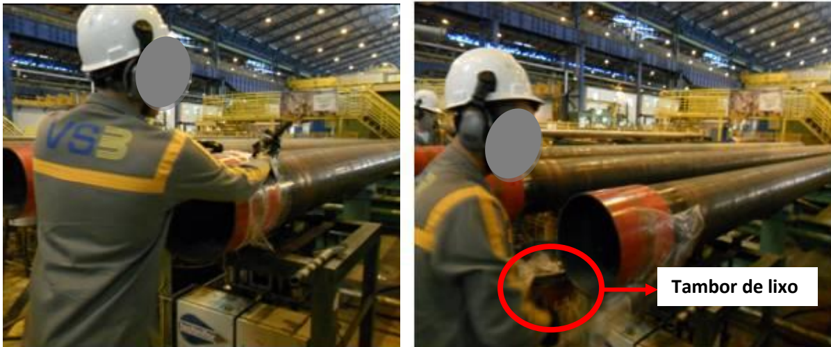
Figura 05 – Retirada de plástico.
