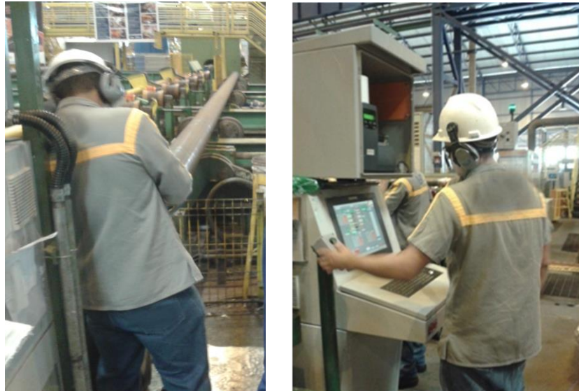
Figura 31 – Conferência de numeração em tubo e consulta ao sistema.
