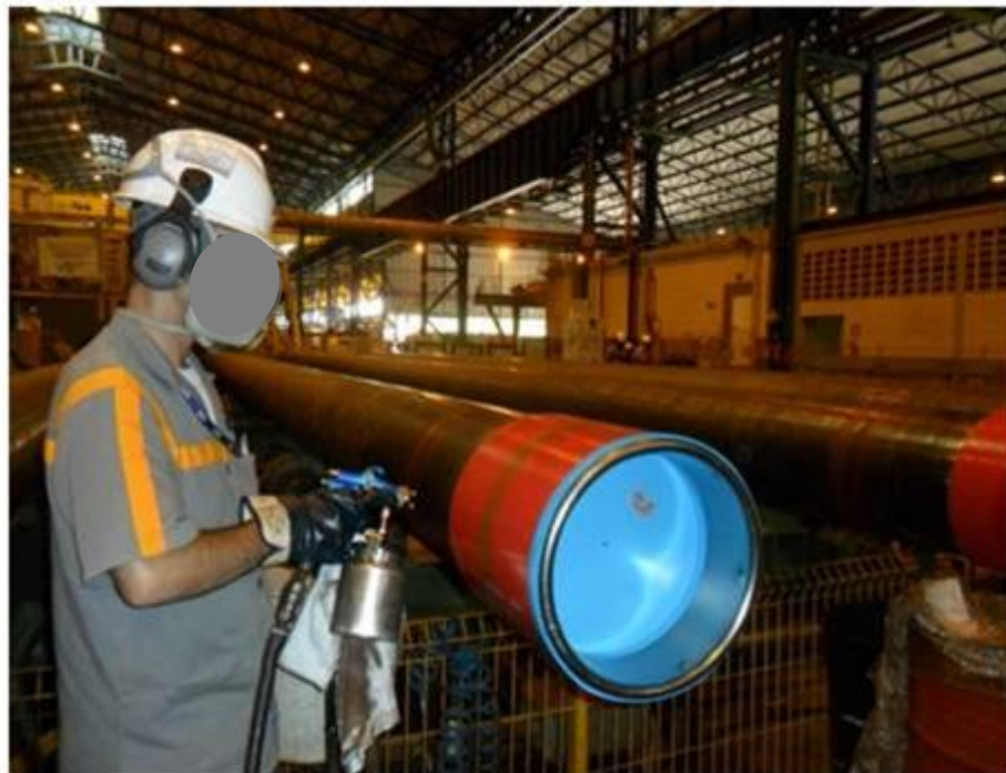
Figura 28 – Aplicação de verniz.
