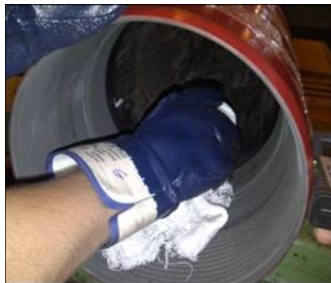
Figura 09 – Sujidade em rosca interna.
