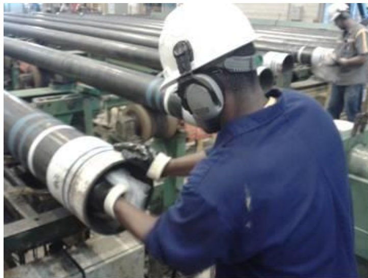
Figura 12 – Retirada de resíduos.
