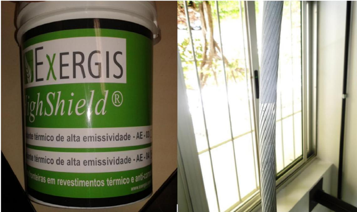
Figura 3.5 - Tinta de recobrimento utilizada e cabo com a metade superior pintada. (PORTELA, 2014).
