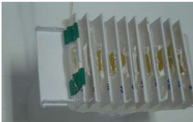
Figura 22: Teste para posicionamento do balão (vazio) e montagem dos filmes a serem irradiados.
