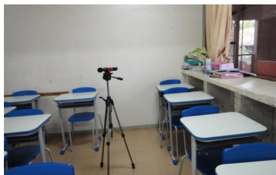
Figura 3.6: Medidor de nível de pressão sonora posicionado (medição do ruído de fundo e L_{eq} ).
