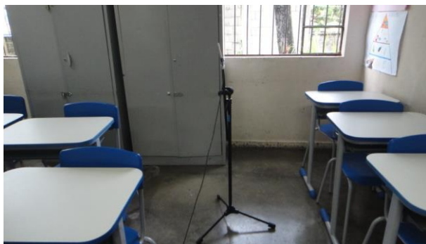
Figura 3.7: Microfone omnidirecional TIPO 1 BSWA TECH modelo MA 211 durante medição do T_{30} e STI.
