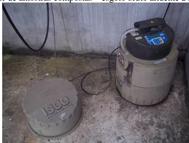
Figura 5.1 Coletor de amostras compostas – esgoto bruto afluente à ETE Betim Central
