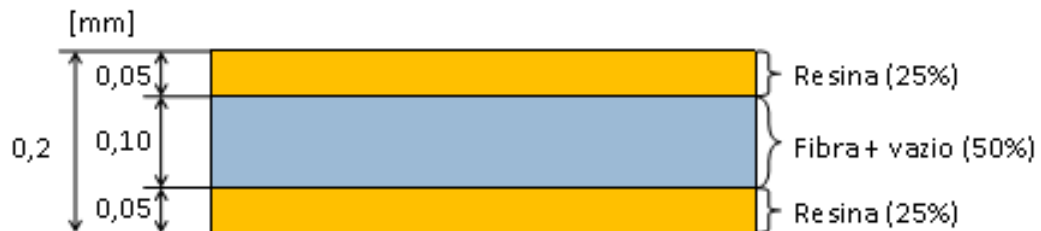
Figura 34. Esquema da lâmina de reforço e suas proporções volumétricas
