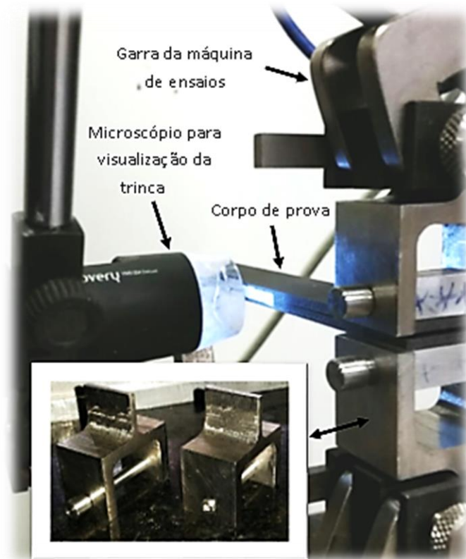
Figura 29. Montagem de um CP de ensaio DCB e, em detalhe, o dispositivo fabricado
