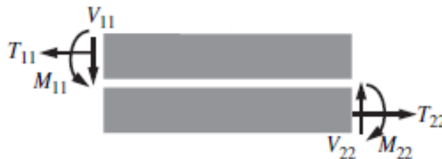
Figura 12. Condições de contorno para juntas sobrepostas simples carregadas axialmente (DA SILVA; ÖCHSNER, 2008)
