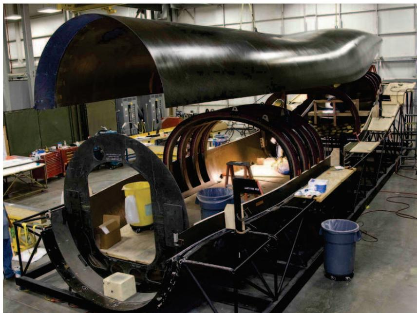
Figura 2: Montagem da fuselagem do cargueiro X-55A
