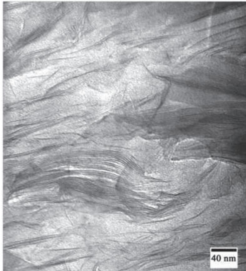
Figura 17: Microscopia TEM de um nanocompósito de montmorillonita, mostrando ambas as morfologias intercaladas e esfoliadas
