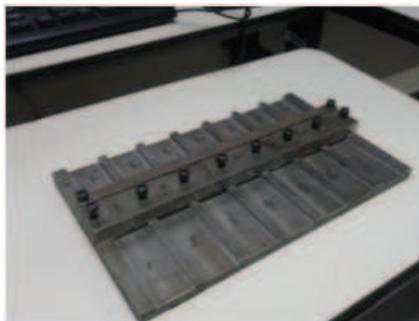
Figura 31: Dispositivo guia para colagem de juntas
