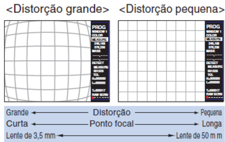
FIGURA 4.1 - Distorções em uma lente.
