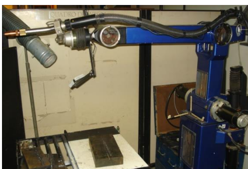
FIGURA 5.1 - Manipulador com cinco graus de liberdade. FONTE: O AUTOR, 2015.
