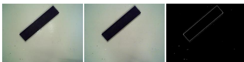
(a) com iluminação; (b) sem iluminação; (c) detecção de bordas.
