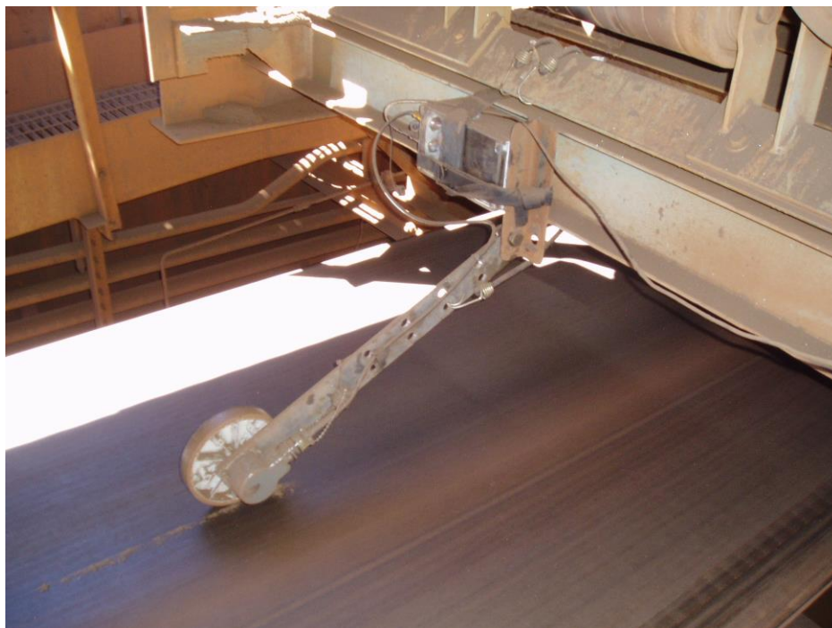
FIGURA 2.48 - Dispositivo para medição de velocidade da correia (Tecnometal Engenharia e Construções Mecânicas Ltda.)
