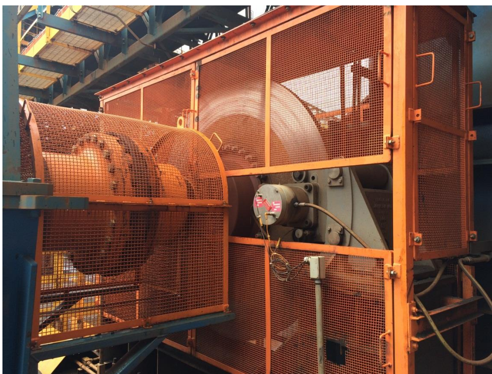
FIGURA 2.13 - Freio aplicado no eixo de baixa rotação (Sandvik MGS S/A)
