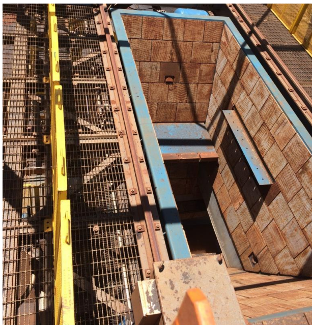
FIGURA 2.24 - Parte interna de um chute e suas chapas de desgaste (Sandvik MGS S/A)
