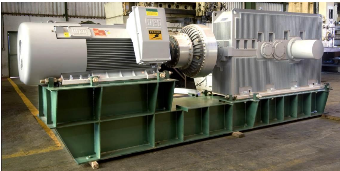
FIGURA 2.4 - Sistema de acionamento montado em sua base (Tecnometal Engenharia e Construções Mecânicas Ltda.)
