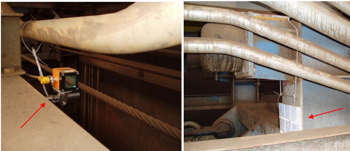
FIGURA 2.50 - Sensor laser para medição do curso do esticamento (Tecnometal Engenharia e Construções Mecânicas Ltda.)
