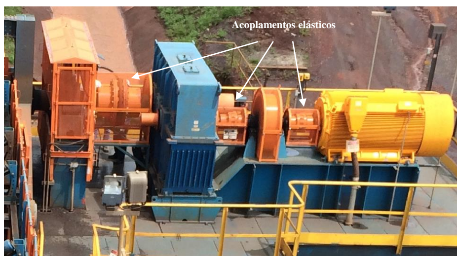
FIGURA 2.10 - Sistema de acionamento com acoplamentos elásticos (Sandvik MGS S/A)
