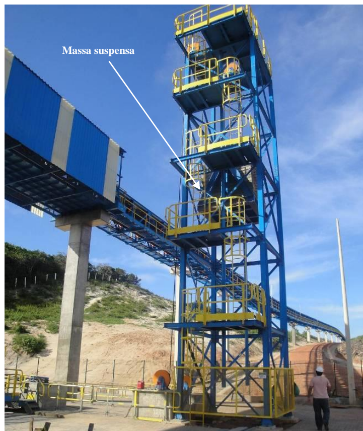
FIGURA 2.22 - Sistema de esticamento por gravidade (Tecnometal Engenharia e Construções Mecânicas Ltda.)
