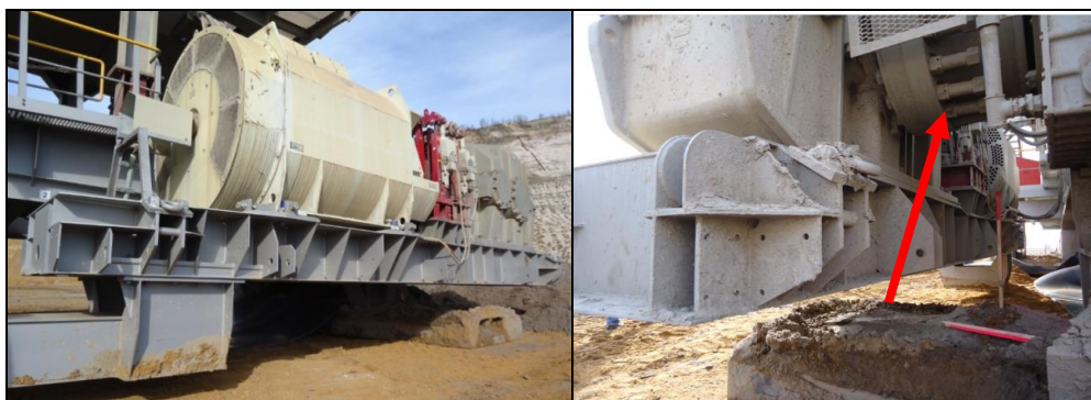
FIGURA 2.12 - Sistema de acionamento com acoplamento rígido (Sandvik MGS S/A)
