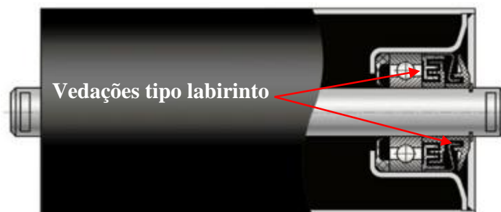
FIGURA 2.42 - Rolo e suas vedações ( http://newmachineparts.blogspot.com.br/2012/12/packing-seals-and-gaskets.html )
