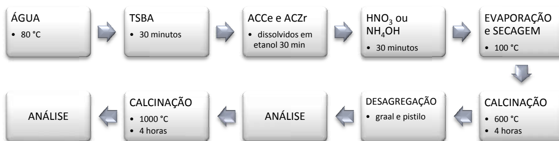
Figura 4.3: Descrição esquemática da síntese para as amostras do DOE.
