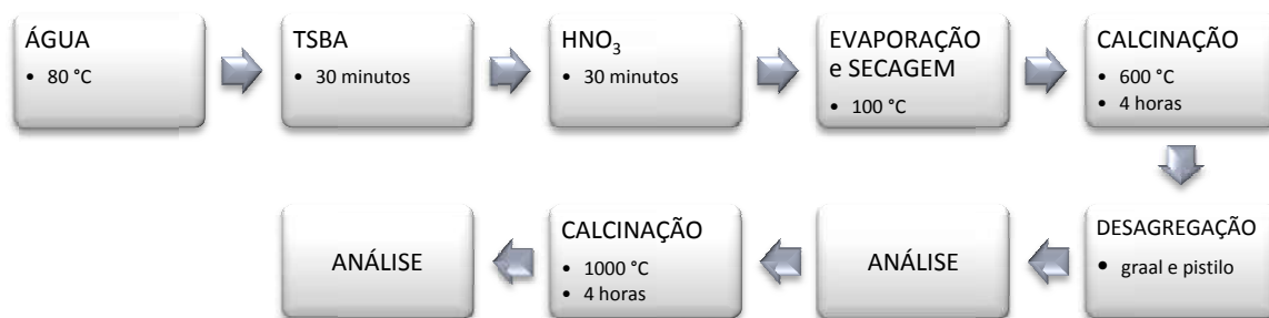
Figura 4.1: Descrição esquemática da rota de síntese para a amostra Y0.
