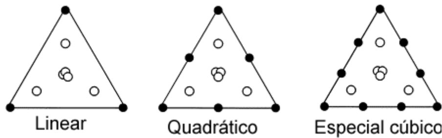
Figura 3.23: Representação dos modelos e dos pontos de análise de planejamento de misturas. Adap. [150] .
