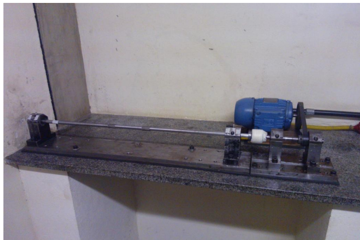
Figura 21 – Bancada Compacta de Testes Dinâmicos.
