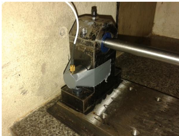
Figura 22 – Fixação do sensor de EA ao suporte do mancal esquerdo.
