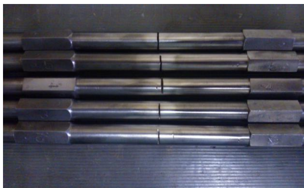
Figura 16 – Simulações de trinca transversal.
