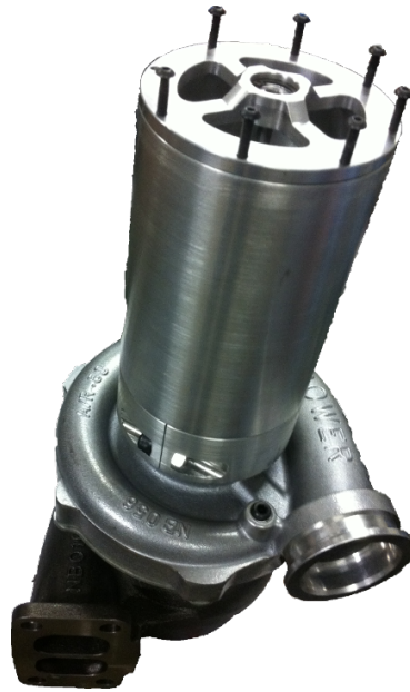
Figura 6.5 – Protótipo construído da versão mono- e bi-apoiada.
