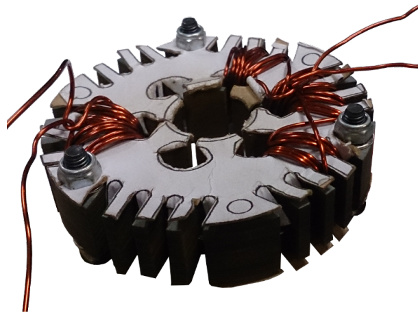
Figura 4.10 – Núcleo APERAM cortado e montado para ensaio, em bancada, das propriedades magnéticas.
