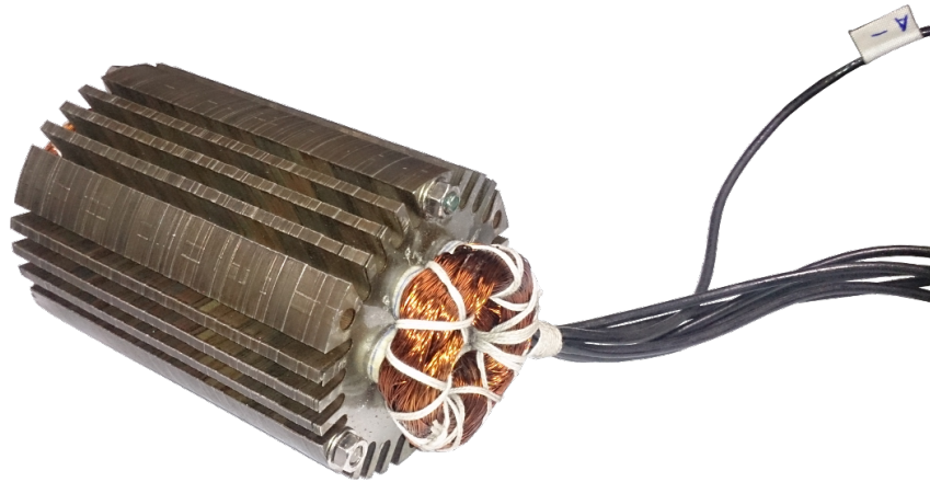
Figura 5.17 – Protótipo do estator fabricado segundo o dimensionamento apresentado.
