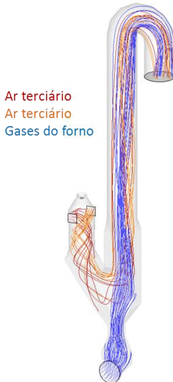
Figura 4-13 Trajetórias das partículas de fluido no interior do Calcinador B
