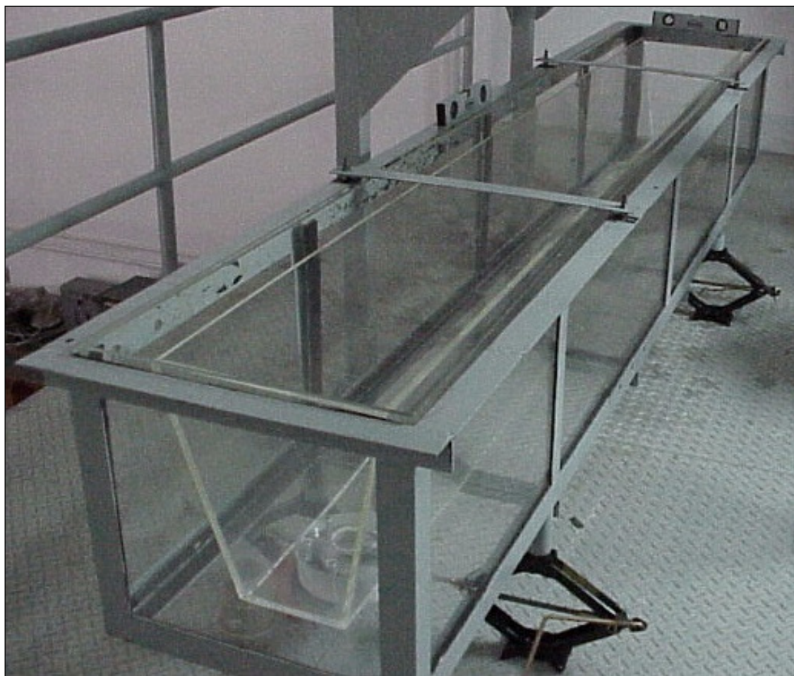
Figura 4.3: Modelo físico do distribuidor de lingotamento contínuo.
