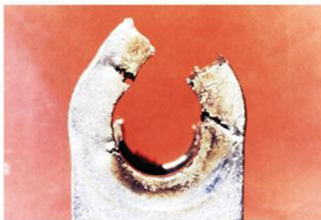
Figura 3. 17 - Parte de peça de aço inoxidável, fraturada por corrosão sob tensão fraturante (GENTIL, 2003).
