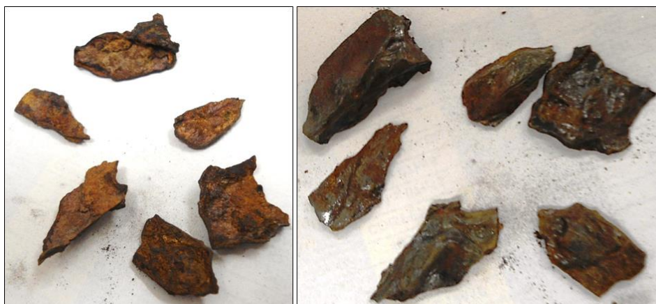
Figura 5. 116 - Tubérculos coletados na tubulação de EB2, amostra 5.
