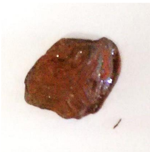
Figura 5. 103 - Tubérculo retirado da descarga de EB2.
