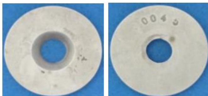
Figura 5. 148 - Cupom 3 após a decapagem: lado que ficou em contato com a polpa e lado do fundo.
