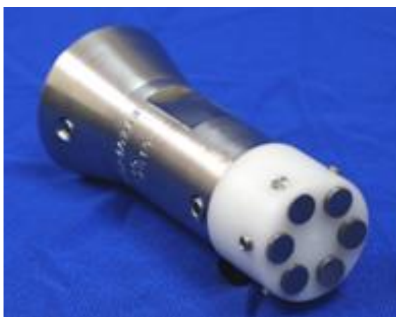
Figura 4. 5 - Modelo de biocupom utilizado nos testes (METAL SAMPLES CORROSION MONITORING SYSTEMS).
