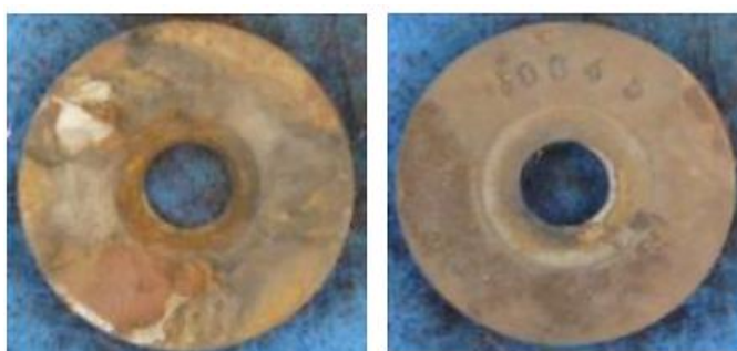
Figura 5. 147 - Cupom 3 antes da decapagem: lado que ficou em contato com a polpa e lado do fundo.
