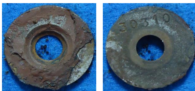
Figura 5. 144 - Cupom 2 antes da decapagem: lado que ficou em contato com a polpa e lado do fundo.
