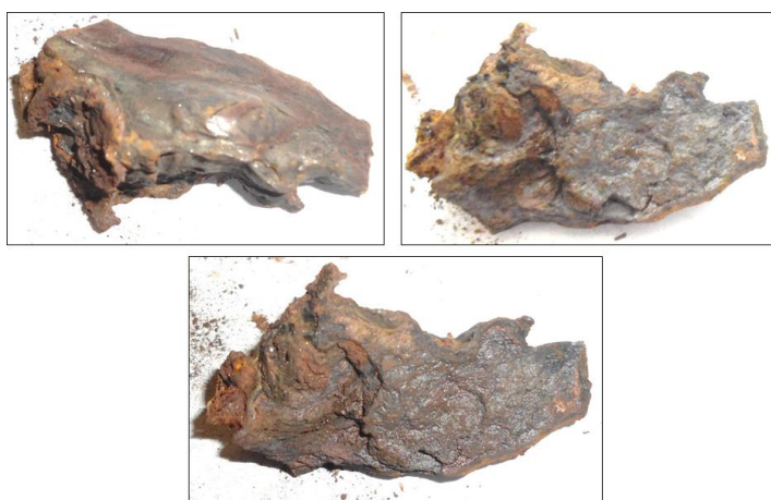
Figura 5. 112 - Tubérculos coletados na tubulação de EB2, amostra 3.
