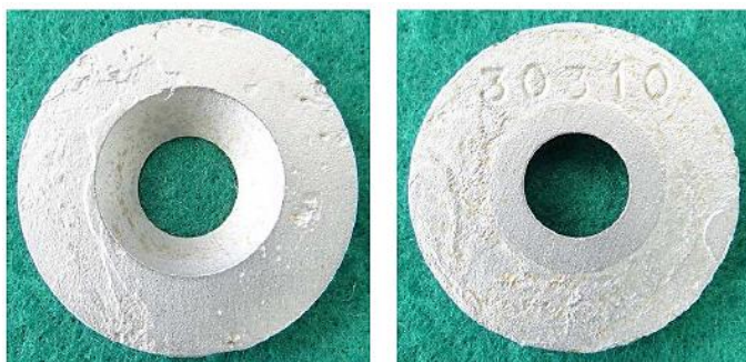
Figura 5. 145 - Cupom 2 após a decapagem: lado que ficou em contato com a polpa e lado do fundo.
