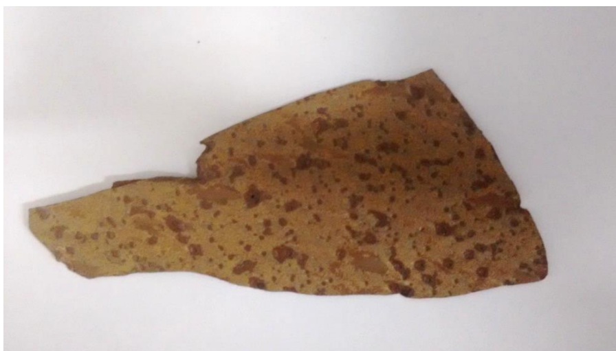
Figura 5. 97 - Amostra retirada do loop de EB1 (face em contato com a parede).
