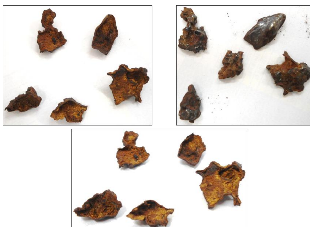
Figura 5. 114 - Tubérculos coletados na tubulação de EB2, amostra 4.
