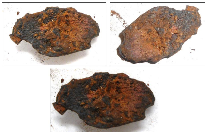
Figura 5. 110 - Tubérculos coletados na tubulação de EB2, amostra 2.
