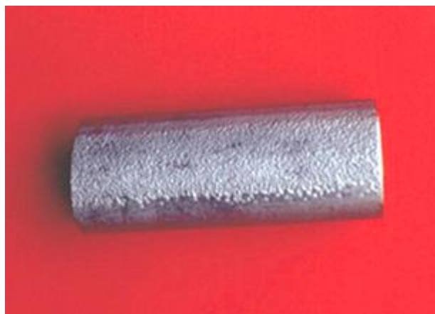
Figura 3. 20 - Corrosão por aeração diferencial em um dos lados do tubo (GENTIL, 2003).
