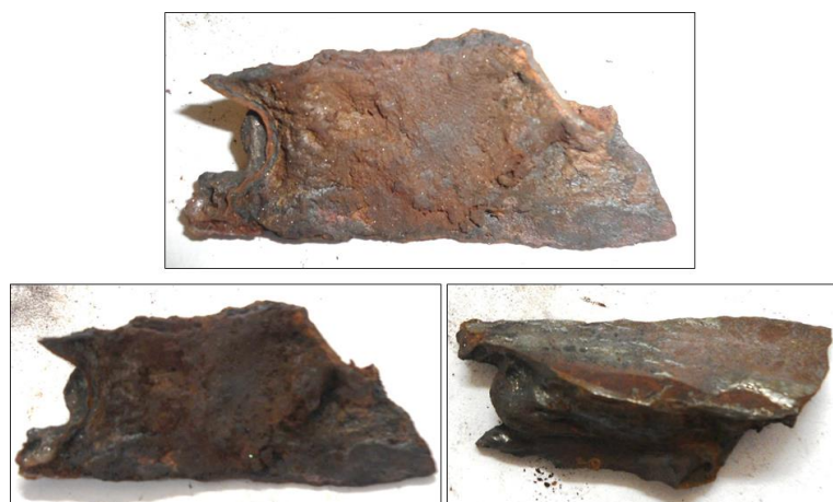
Figura 5. 108 - Tubérculos coletados na tubulação de EB2, amostra 1.
