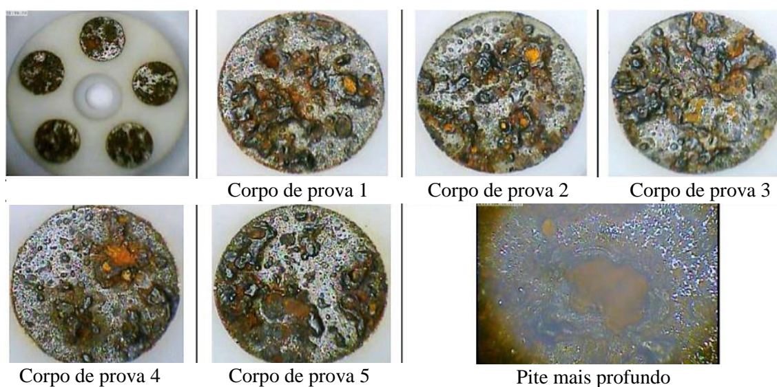
Figura 5. 153 - Biocupom, cinco corpos de prova e o pite mais profundo encontrado.
