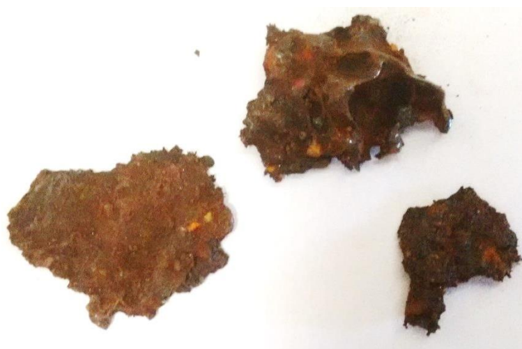
Figura 5. 100 - Amostra removida pelo pig de limpeza.
