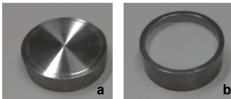
Figura 4.4: Amostras para análise química após preparação: (a) aço (b) escória
