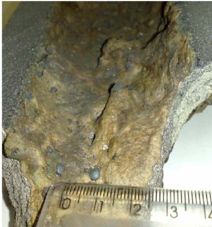
Figura 3.21: Válvula submersa com obstrução parcial durante o lingotamento do aço 409 (SILVA, 2009).
