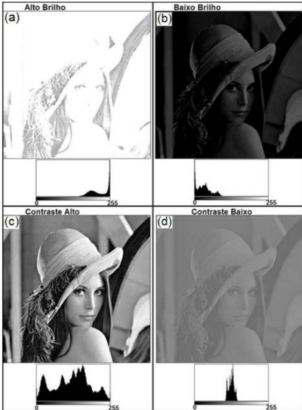
Figura 3.23 – exemplo de imagens monocromáticas com diferentes ajustes de brilho e contraste e seus respectivos histogramas. (a) imagem clara, alto brilho; (b) imagem escura, baixo brilho; (c) imagem com alto contraste; (d) imagem com baixo contraste. Delbem (2014).
