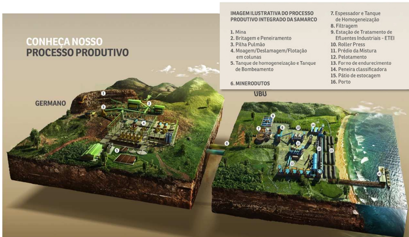
Figura 3.5 – Fluxograma esquemático do processo produtivo da Samarco Mineração (Apresentação institucional Samarco)
