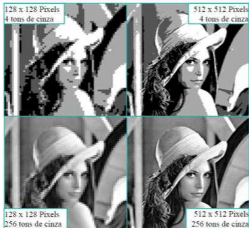
Figura 3.21 – Imagem digital com variação de resolução espacial e de intensidade. (Paciornik, 2011 apud Mantilla, 2013).
