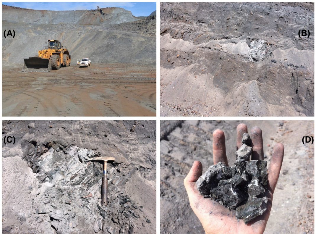
Figura 4.6 – (A) e (B) Aspecto geral do minério da AGEO 91. (C) Detalhe do minério da AGEO 91 in situ . (D) Detalhe da fragmentação do minério.
