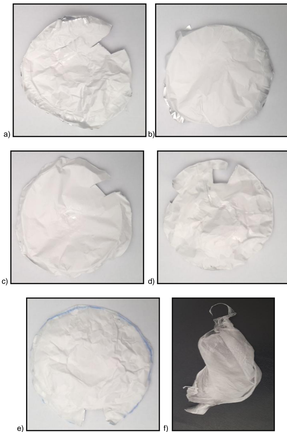
Figura 5.12: Fotografia para as amostras com concentrações de progesterona de a) 9% m/m , b) 16% m/m , c) 23% m/m , d) 28% m/m , e) 33% m/m e f) 16% m/m após ser retirada do papel alumínio. Escala: 1:2.
