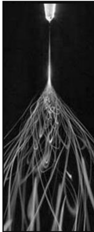
Figura 3.9: Fotografia das nanofibras saindo da agulha durante o método de eletrospinning.
