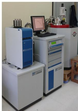
**Figura 3.8:** Sistema PPMS instalado no Lemag do DF/UFES.
