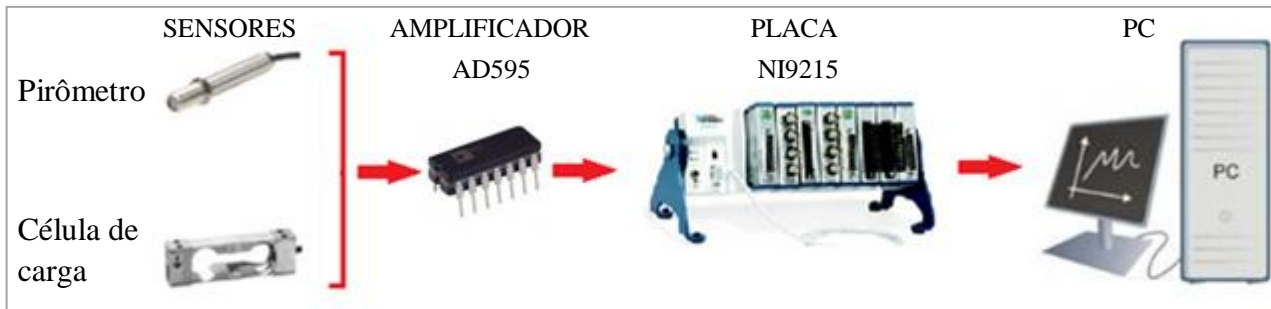
Figura 3.7 - Diagrama do sistema de aquisição de dados.
