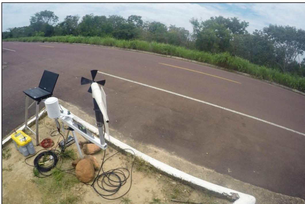
FIGURA 4.2 - Estação Meteorológica montada à beira da rodovia LMG 674.
