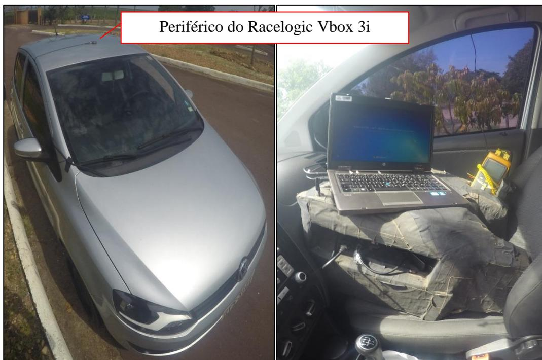
FIGURA 4.1 - Volkswagen Fox instrumentado com GPS Racelogic VBox 3i.
