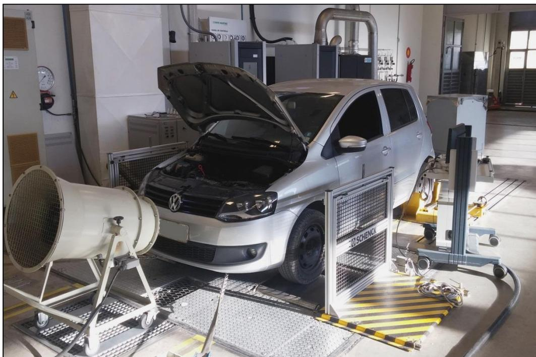
FIGURA 4.3 - Veículo posicionado para simulação das forças resistivas pelo dinamômetro.
