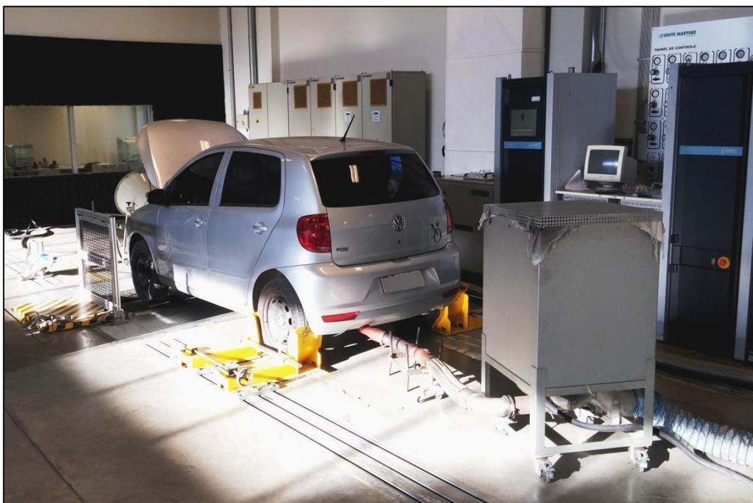
FIGURA 4.4 - Veículo instrumentado com os equipamentos necessários para o ensaio de determinação de CO<sub>2</sub> e do consumo de combustível.
