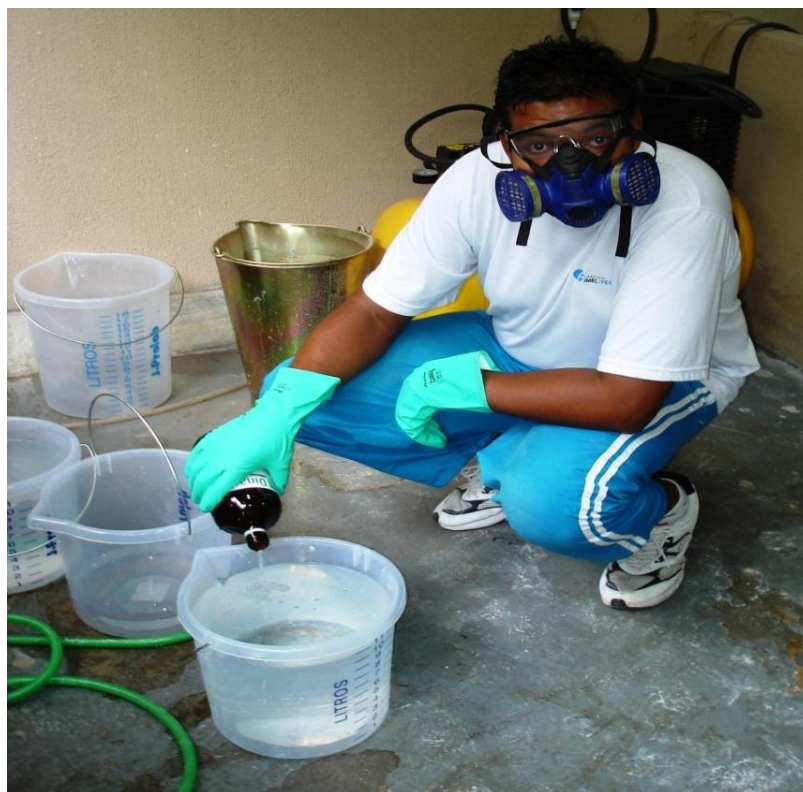
Figura 4.9.1 - Preparação da solução de ácida de ataque.
