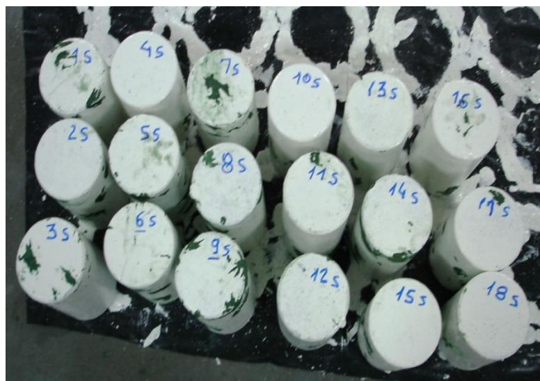
Figura 4.8.6 - Corpos de prova com pintura final e calafetados com massa epóxi
