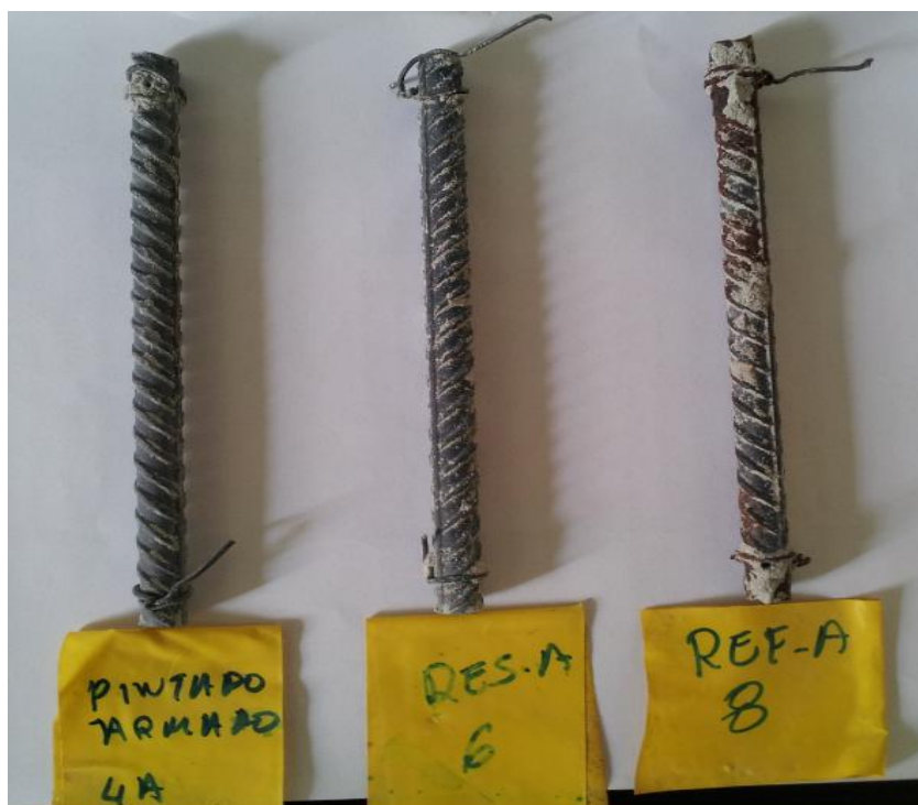
Figura 5.2.3.3.13 - Aço das armaduras dos corpos de prova. Atacados 150 dias.
