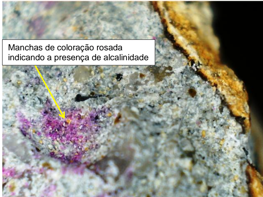
Figura 5.2.3.2.15 - Corpo de prova resina armado 5. Concreto apresentando alcalinidade, próximo à borda atacada. Ampliação 400X com lupa estereoscópica.
