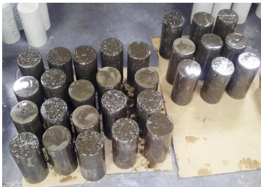
Figura 4.8.3 – Aplicação do selador epóxi dos corpos já pintados.
