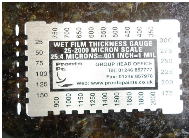
Figura 4.8.5 - Primeira demão epóxi novolac, medição da espessura da película úmida 150 \mu m.
