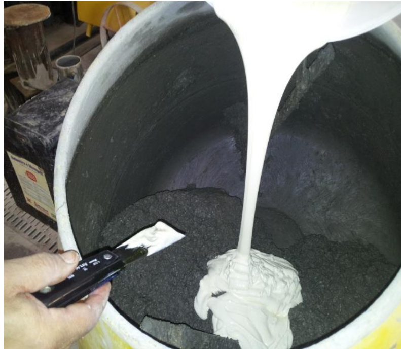
Figura 4.6.2.3 - Mistura da resina ao concreto, juntamente com a última parte da água .
