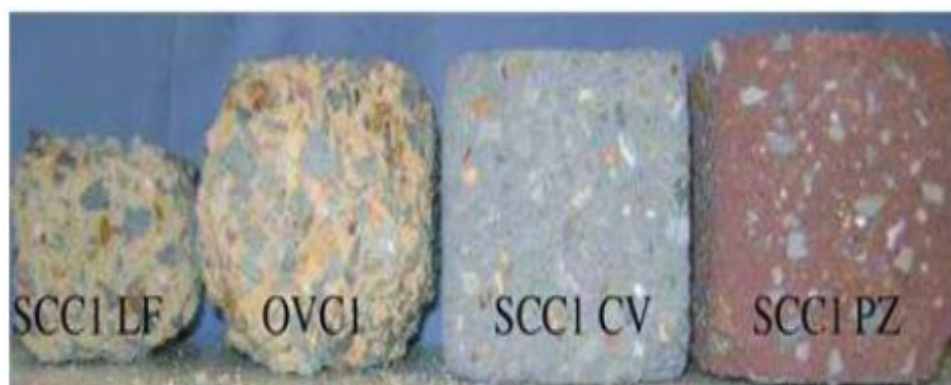
Figura 3.3.1 - Fotografia corpos de prova de concreto deteriorados após 12 semanas de imersão em solução de HCl de 5%. Fonte: Siad et al. 2010
