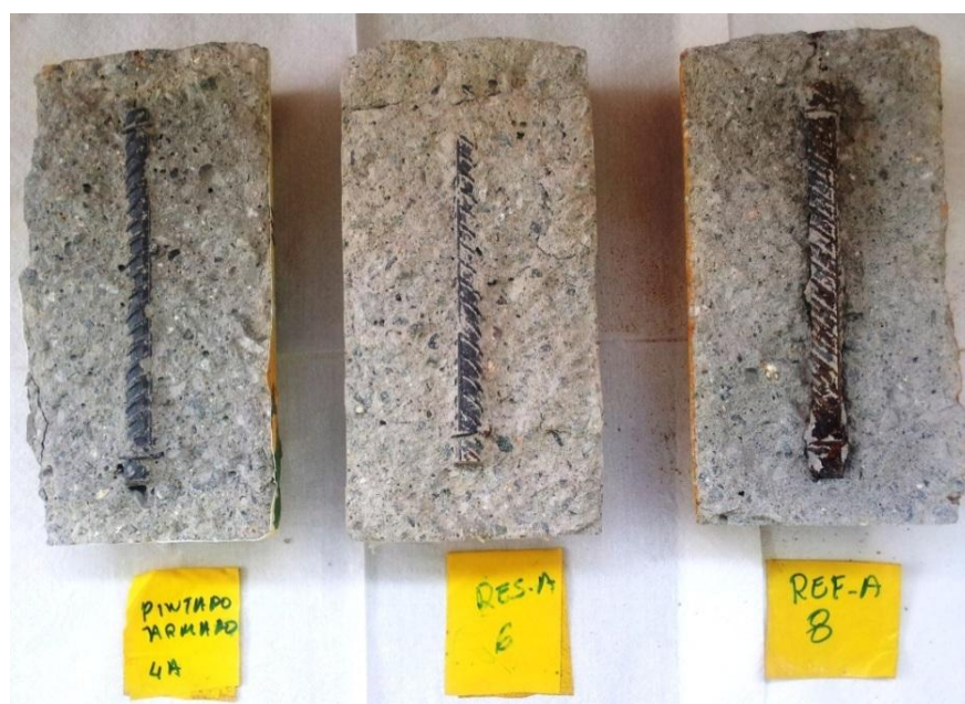
Figura 5.2.3.3.12 – Fotografia dos corpos de prova abertos por compressão axial.
