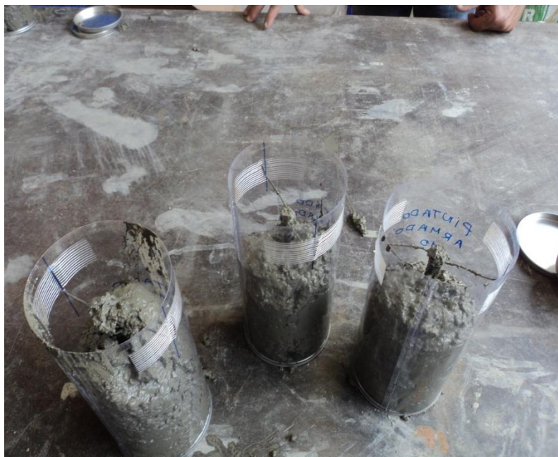
Figura 4.6.2.5 - Moldagem dos corpos de prova armados.
