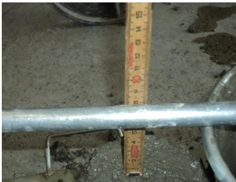
Figura 4.3.3 Slump teste (62 mm) do traço concreto referência 3 com adição da resina epóxi.
