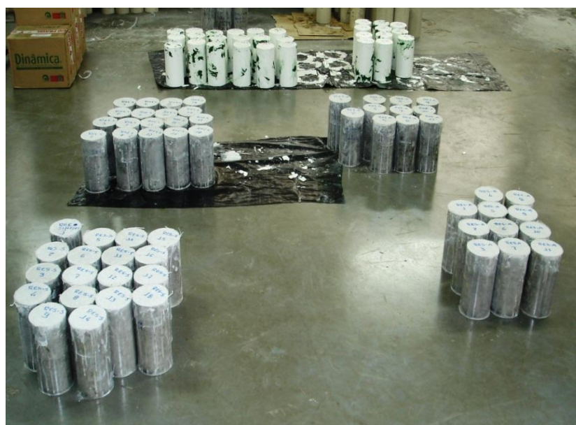
Figura 4.8.7 - Corpos de prova separados por série, prontos para serem colocados na solução ácida de ataque.
