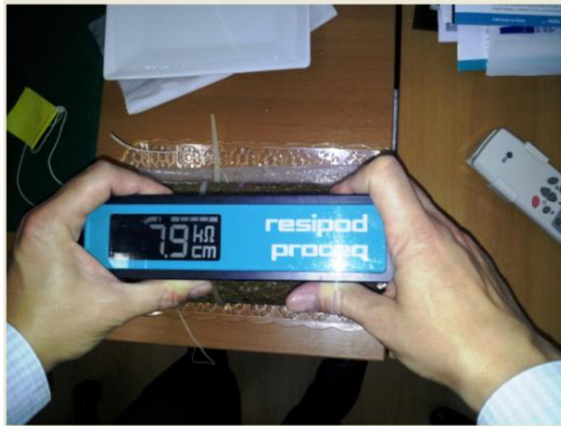
Figura 5.2.3.1.11 Execução do ensaio de resistividade.
