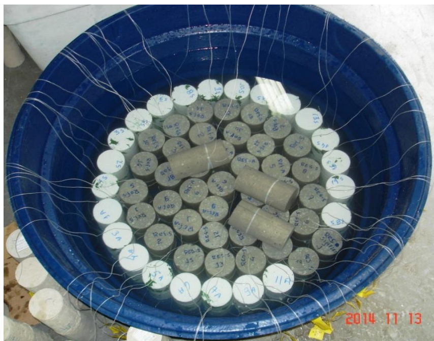
Figura 4.9.2 - Corpos de prova já colocados na solução ácida de ataque.
