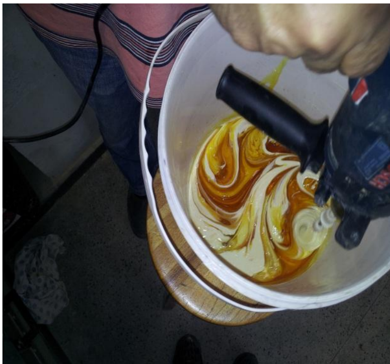
Figura 4.6.2.1 - Mistura da resina epóxi e do agente de cura.
