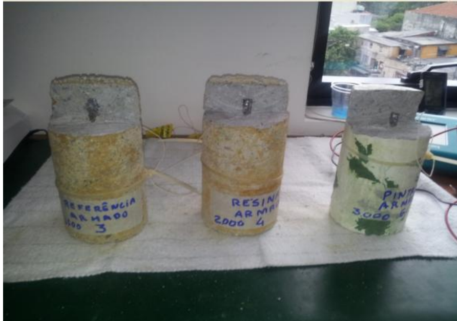
Figura 5.2.3.1.7 - Preparação dos corpos de prova para o ensaio de potencial de corrosão.
