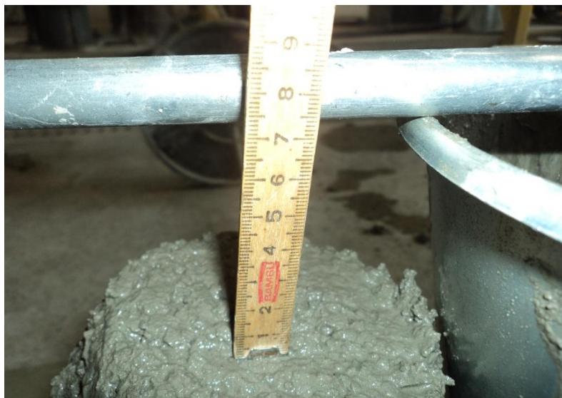
Figura 4.3.2 - Slump teste (75 mm) do traço do concreto referência 3 sem adição da resina epóxi.
