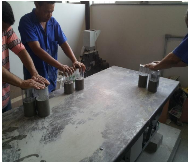
Figura 4.6.1.1 - Moldagem dos corpos de prova concreto referência e pintados - primeira etapa.
