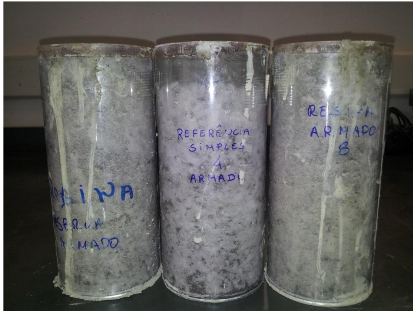
Figura 4.6.2.7 - Corpos de prova após 3 dias de cura . Concreto ainda apresenta umidade dentro das formas descartáveis.
