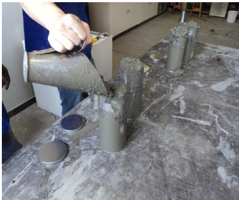
Figura 4.6.1.2 - Moldagem dos corpos de prova concreto referência e pintado - segunda etapa.
