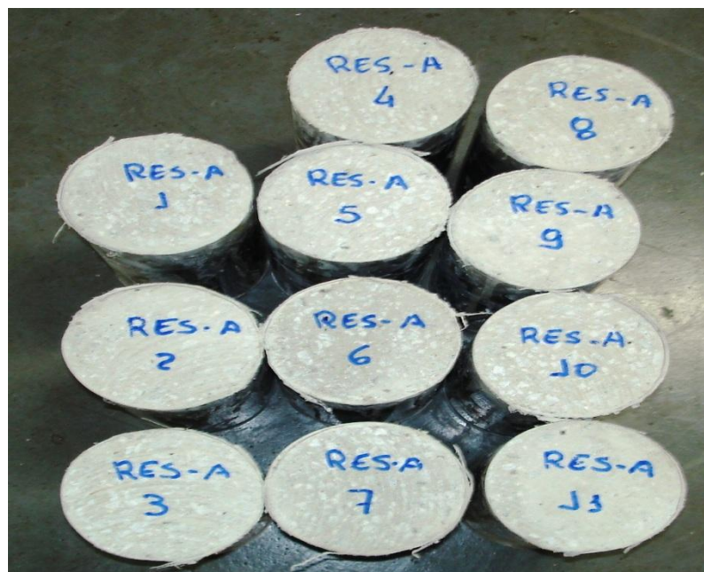
Figura 4.7.1 - Corpos de prova retificados e identificados.
