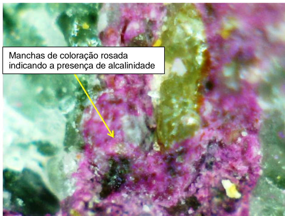
Figura 5.2.3.2.14 - Corpo de prova resina armado 5. Concreto apresentando alcalinidade próximo armadura. Ampliação 400X com lupa estereoscópica.
