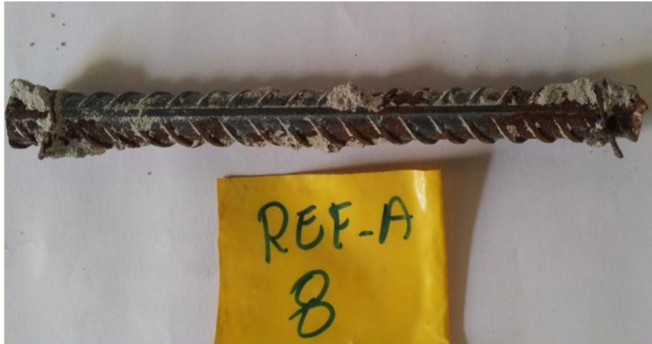
Figura - 5.2.3.3.17 – Armadura retirada do corpo de prova referência armado 8 após 150 dias de ataque.
