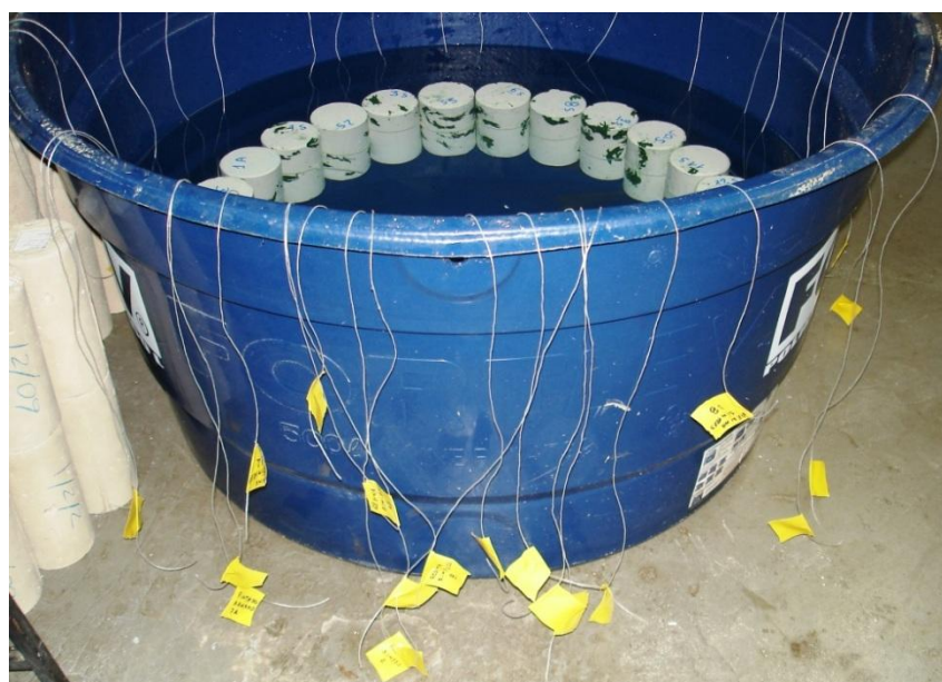
Figura 4.9.3 - Detalhe do sistema de identificação dos corpos de prova utilizando fita plástica de sinalização .
