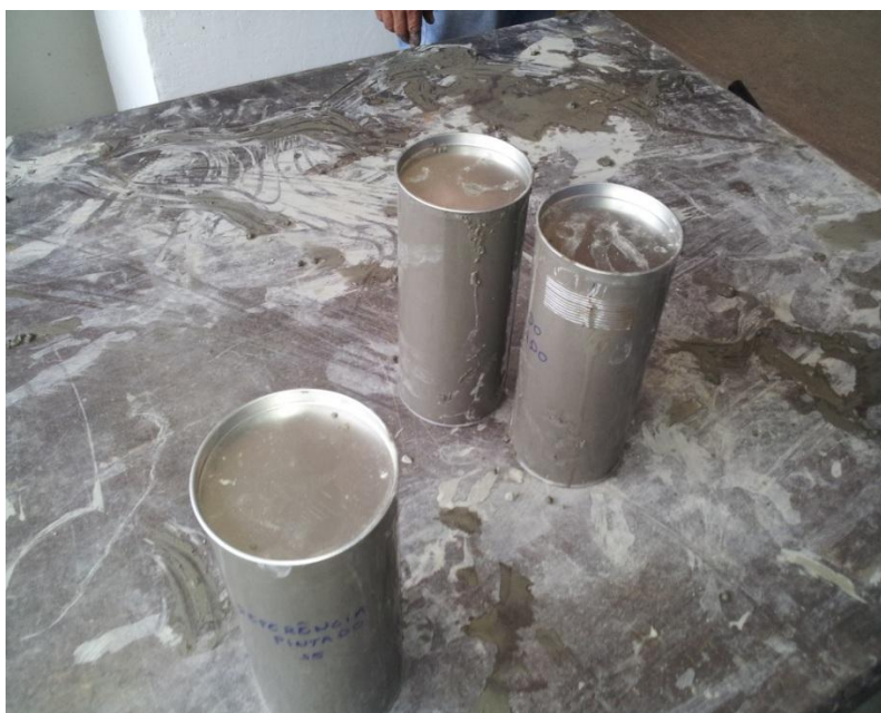
Figura 4.6.2.6 - Formas tampadas após moldagem final.
