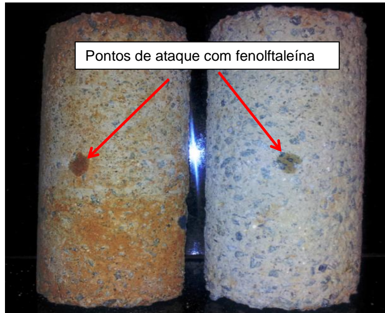
Figura 5.2.3.2.9 - Corpos de prova atacados 90 dias. Ensaio com fenolftaleína . Corpo de prova a direita referência armado 5. Corpo de prova a esquerda resina armado 5.
