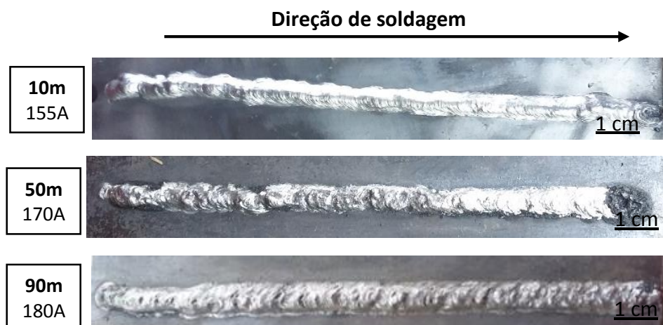
FIGURA C.4. - Cordões de solda com E6013/A36.
