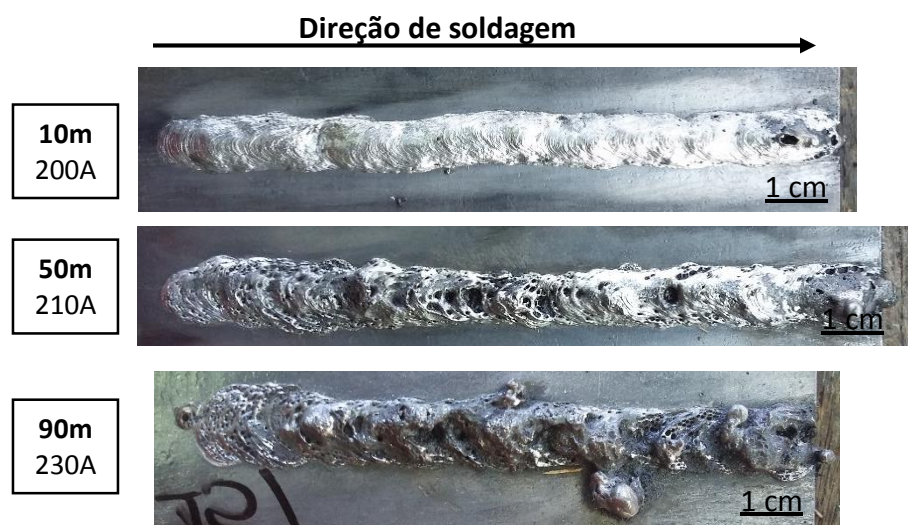
FIGURA C.3. - Cordões de solda com E308L(4,00mm)/A36.
