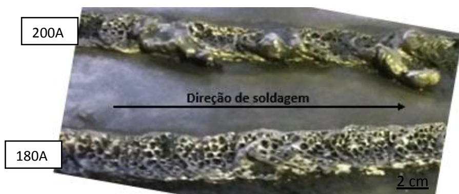
FIGURA 4.3. - Aspecto da superfície do cordão de solda com E316L-17/AH36 à 90 metros de profundidade.
