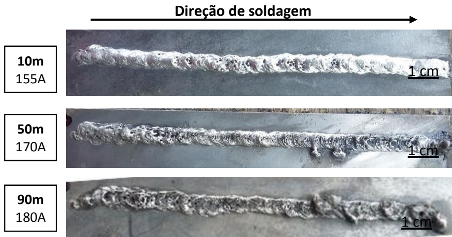
FIGURA C.2. - Cordões de solda com E308L(3,25mm)/A36.
