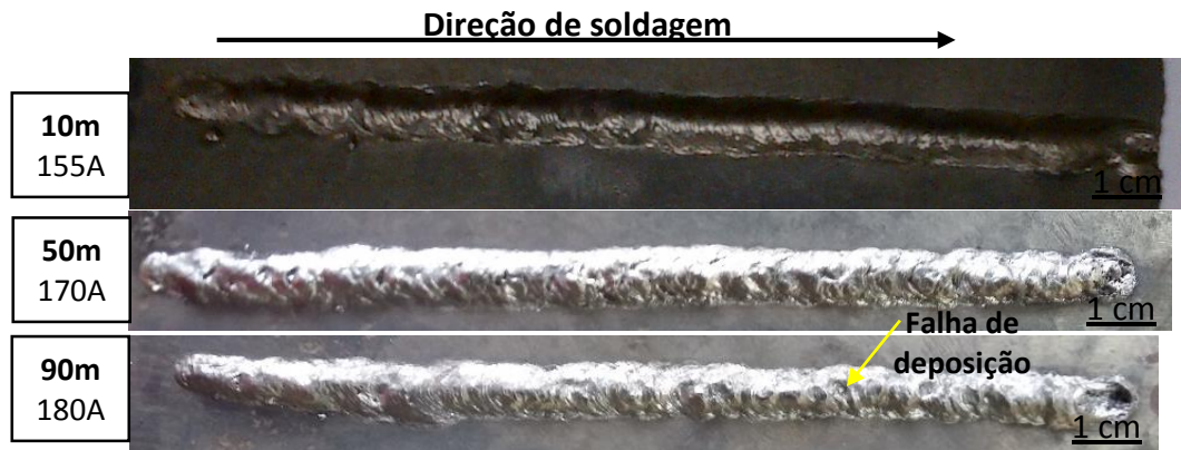
FIGURA 4.5. - Cordões de solda com E6013/AH36.
