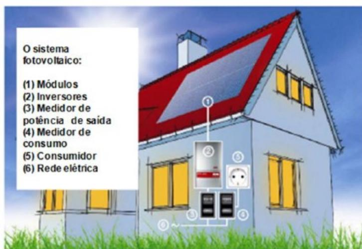
Por meio de cabos a corrente contínua dos módulos fotovoltaicos (1) chega ao inversor onde é convertida em corrente alternada (2) e é injetada na rede pública (6) via medidor de potência de saída (3) e o consumidor (5) consome via medidor de consumo (4).
