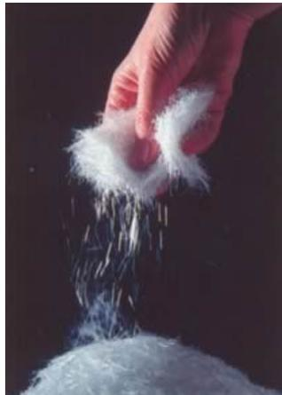
Figura 3.7 - Fibras de vidro para adição em concretos
