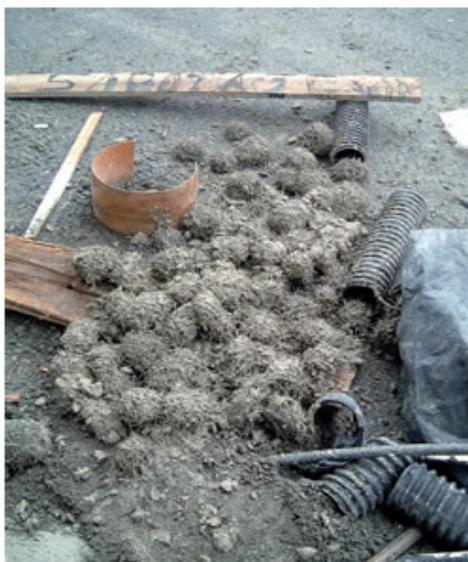
Figura 3.9 – Formação de ouriços (aglomeração das fibras com agregados)
