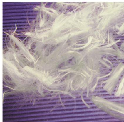
Figura 3.8 - Fibras de polipropileno para adição em concretos
