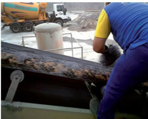
Figura 4.2 – Adição das fibras na usina de concreto.
