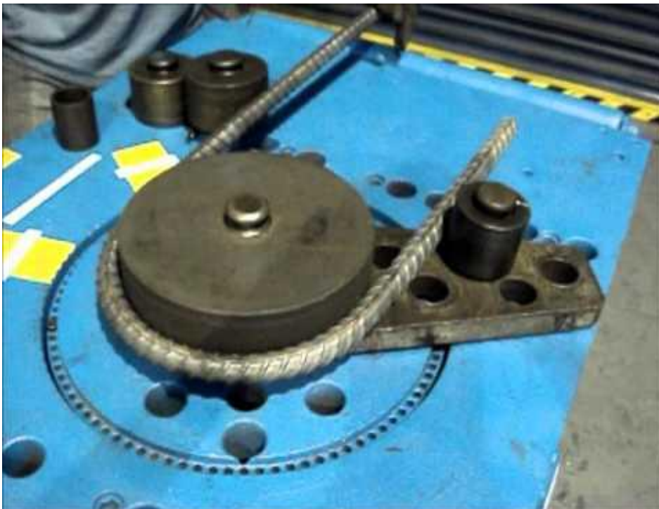
Figura 5 - Dobra do Aço na Máquina
