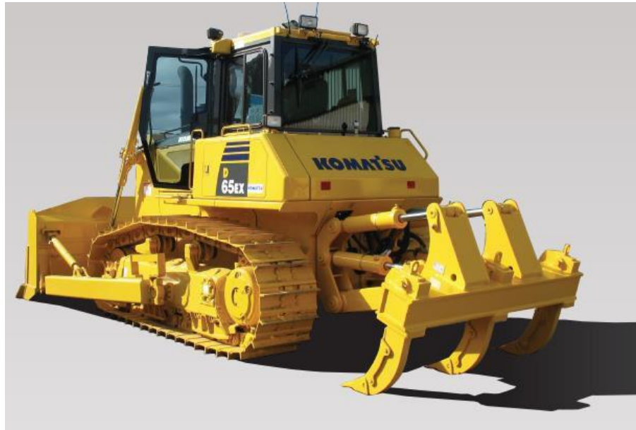
Figura 10 - Trator pesado equipado com escarificador - Komatsu Ripper
