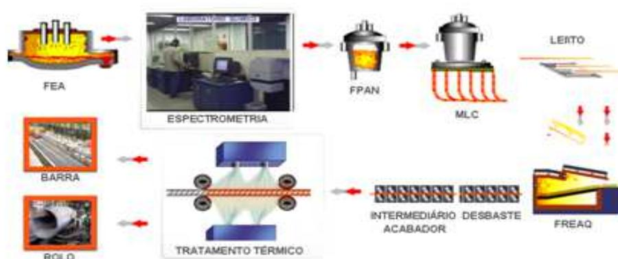
Figura 19 – Fluxo de processo de fabricação CA50-S (fonte: ArcelorMital, 2015)
