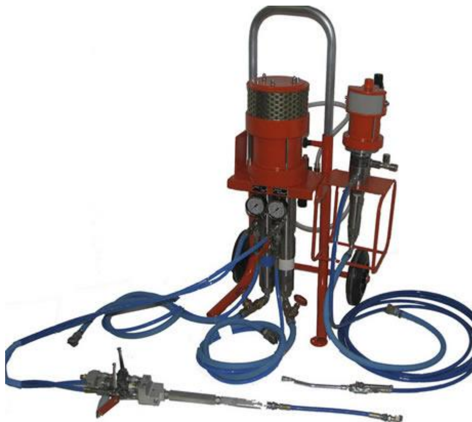
Figura 21 – Equipamento Utilizado para Injetar a Resina nos Bicos
