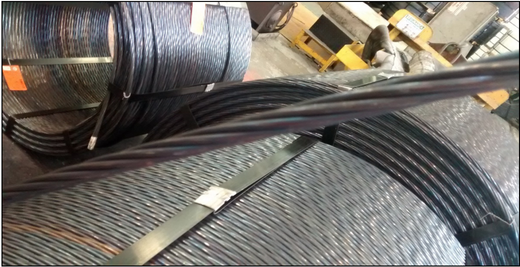
Figura 1.6 - Cordoalha 7 fios para Protensão Fonte: Autor
