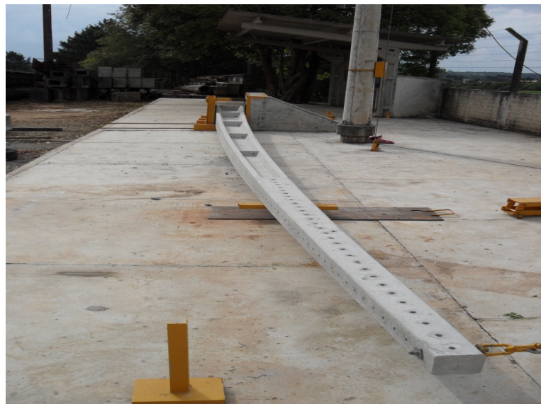
Figura 1.3 – Foto ensaio flecha do poste Fonte: Figura trabalhada pelo eng o Rui Leote
