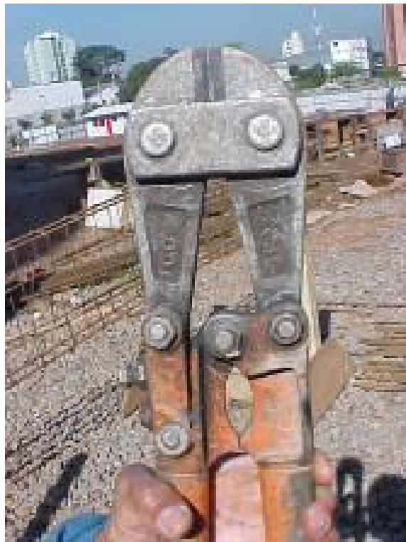
Figura 1.7 - Tesourão utilizado para o corte de barras de aço Fonte: BOTTURA & MELHADO, 2006
