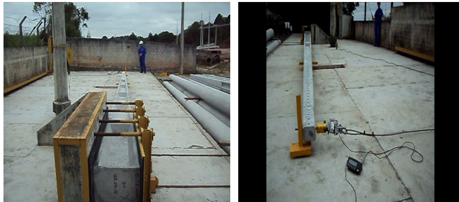
Figura 1.2 – Foto ensaio do poste com flecha residual Fonte: Figura trabalhada pelo eng o Rui Leote
