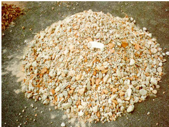
Figura 10 – Entulho na forma de agregado para concreto não estrutural
