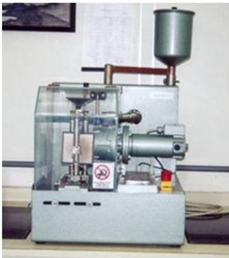
Figura 4.4 – Abrasimetro CAP para medir a abrasão profunda em produtos não esmaltados - Fonte: Menegazzo (2001)
