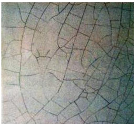
Figura 4.7 – Amostra de Cerâmica com Gretamento – Fonte: Revista Cerâmica (2008)
