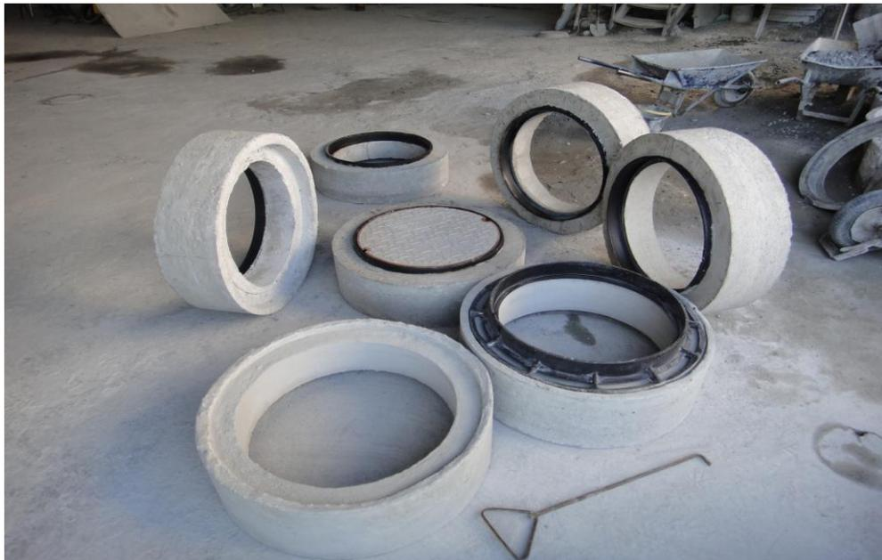
Figura nº 99: Detalhe dos anéis de concreto e aros em ferro fundido. (Fonte: Artefácil)
