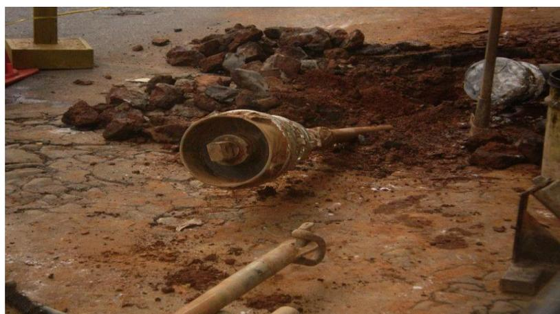
Figura nº 123: Detalhe do alargador. ( Fonte: Tecgas)
