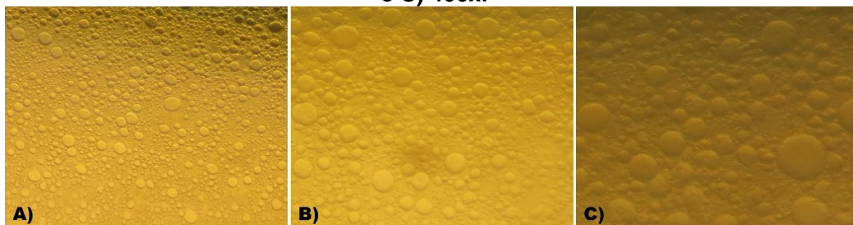
Figura 17 - Fotomicrografias da emulsão F1 com aumentos de A) 100x; B) 200x e C) 400x.
