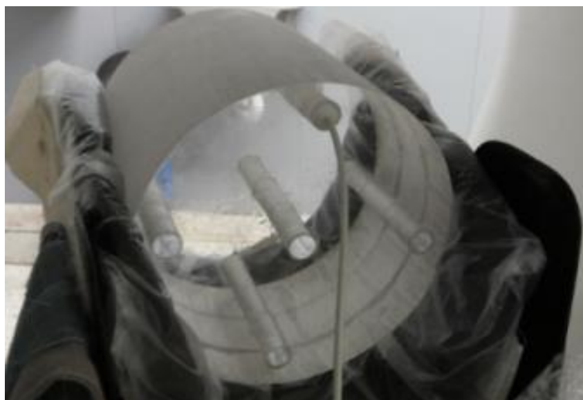
Figura 28, Câmara de ionização posicionada na abertura 12 do objeto simulador de cabeça adulto, que está alinhada ao isocentro do gantry.
