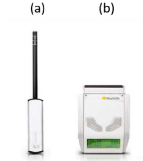
Figura 22 - Câmara de ionização figura (a), eletrômetro figura (b) utilizados neste trabalho.
