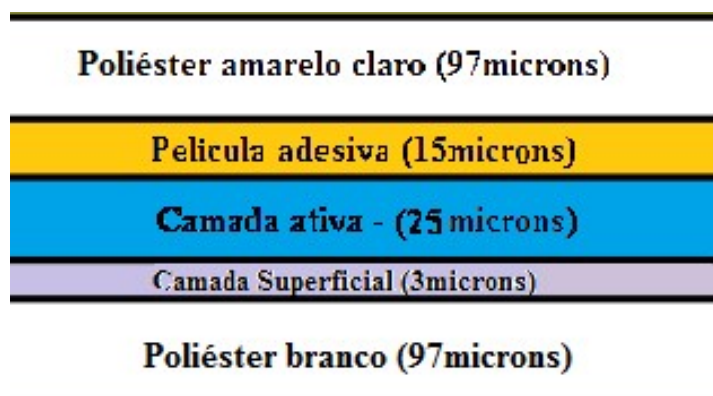
Figura 2.4: Visão geral das camadas do filme radiocrômico.
