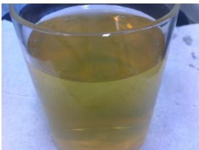
**Figura 5.1** - Solução de NaCl 3,5% (m/v) com coloração dourada, após ensaio de OCP com a amostra de aço AISI 304L recoberta com ZrSiN com 3% de Si.
