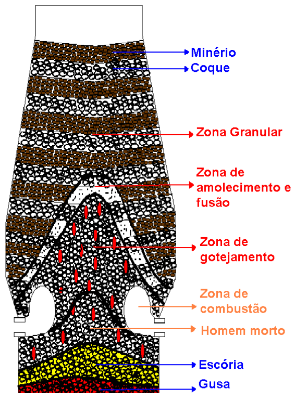
Figura 3.9: Esquema da região interna do alto-forno, mostrando as várias zonas (CASTRO e TAVARES, 1998)
