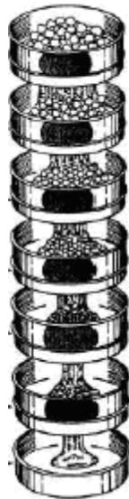
FIGURA 5.2 – Ilustração de um peneiramento a seco em série de peneiras padronizadas.
