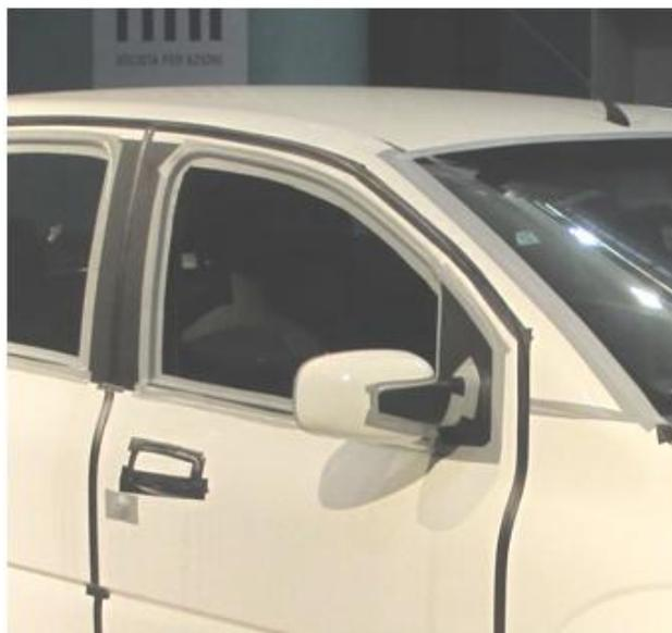
Figura 4.15 – Procedimento realizado na vedação dos contornos próximos ao retrovisor
