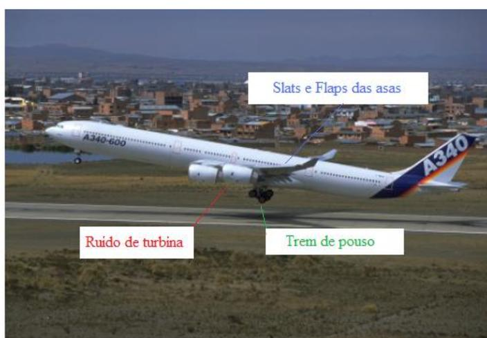
Figura 2.1 – Fontes de ruído aerodinâmico típicas de uma aeronave
