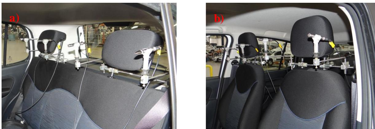
Figura 4.4 – Posicionamento dos microfones internos a) traseiro e b) dianteiro
