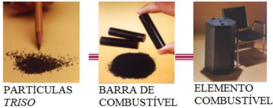
Figura 2.12 – Elementos da matriz de combustível de um VHTR de bloco prismático.
