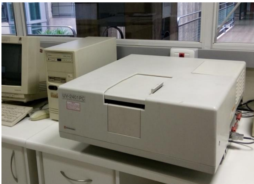
FIGURA 3.10 - Equipamento de Espectroscopia de absorção no UV-Vis - CDTN.
