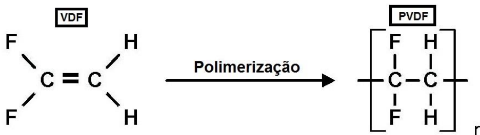
FIGURA 2.3 - Polimerização do Poli(Fluoreto de Vinilideno) – PVDF.
