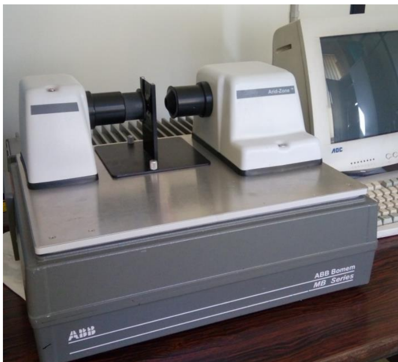
FIGURA 3.11 - Equipamento de Espectroscopia FTIR - CDTN.
