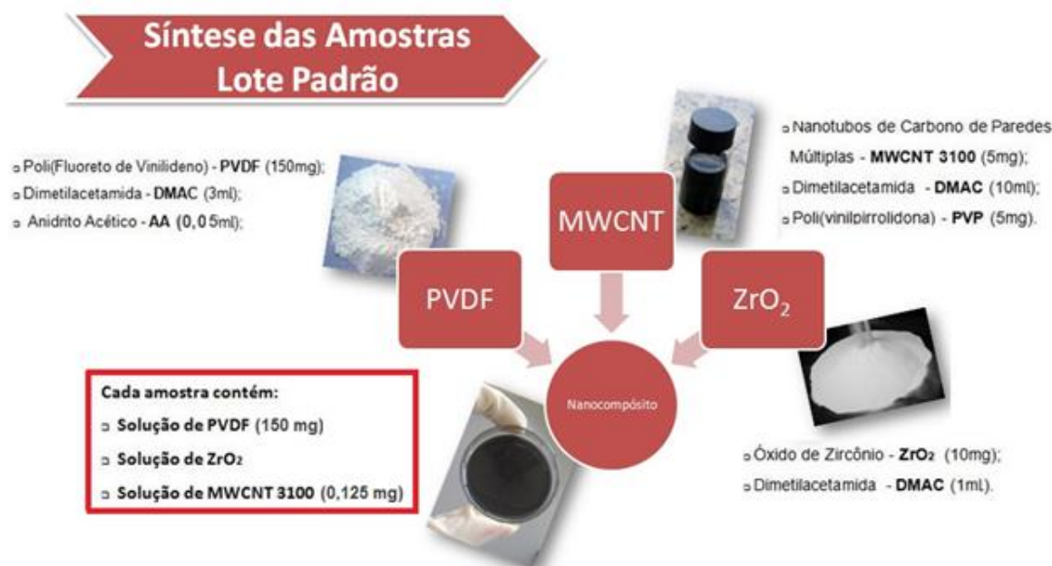
FIGURA 3.4 - Diagrama esquemático do processo de síntese das amostras.
