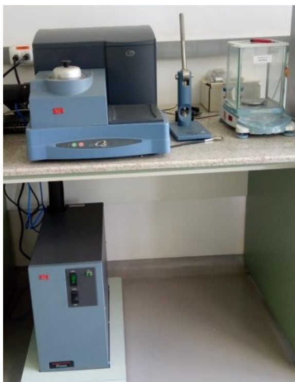
FIGURA 3.8- Equipamento de DSC Q10 TA Instruments do Laboratório de Síntese – CDTN.
