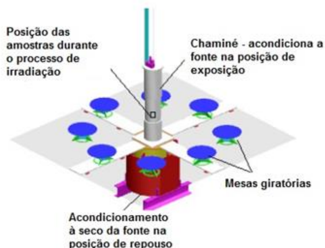
FIGURA 3.5 - Desenho esquemático da câmara de irradiação do LIG - CDTN.
