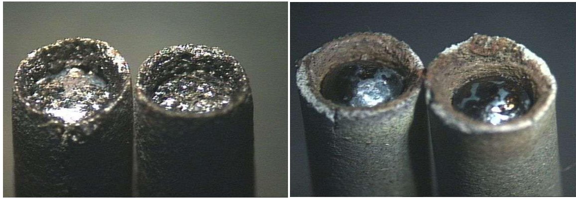
Figura 2.28: (a) Eletrodo com revestimento rutilico; (b) Eletrodo com revestimento básico (Fonte Curso de Especialização em Soldagem, UFMG, 2015)
