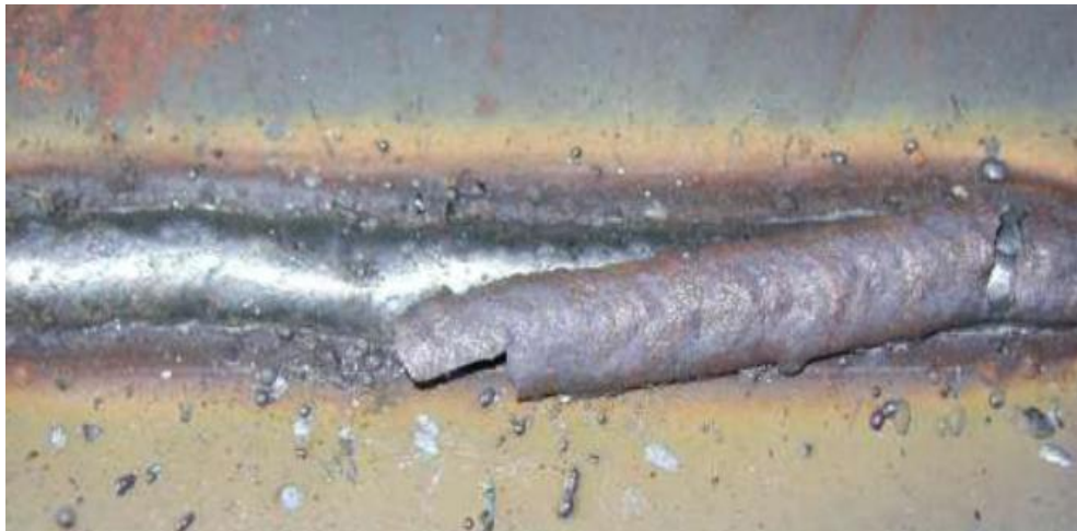
Figura 2.29: Cordão de solda com escória destacada. (Fonte Curso de Especialização em Soldagem, UFMG, 2015)
