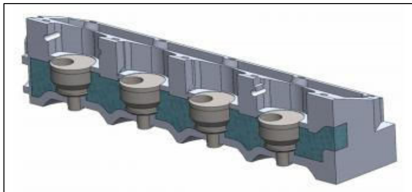
FIGURA 2.20 - Instalação das pré-câmaras feita por Moreira
