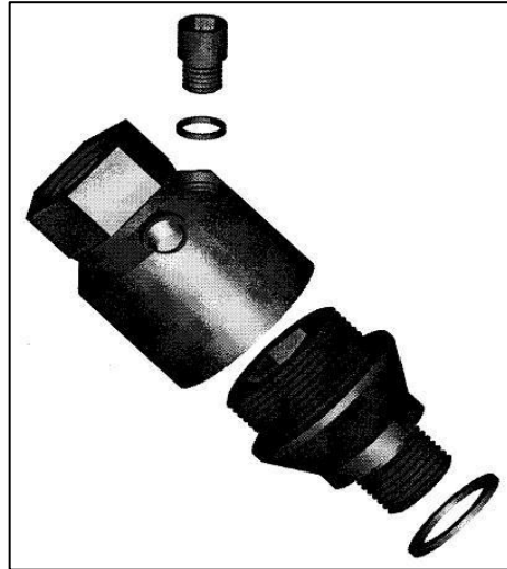
FIGURA 2.15 - Pré-câmara estudada por Sá FONTE - SÁ, 2001, p.69.
