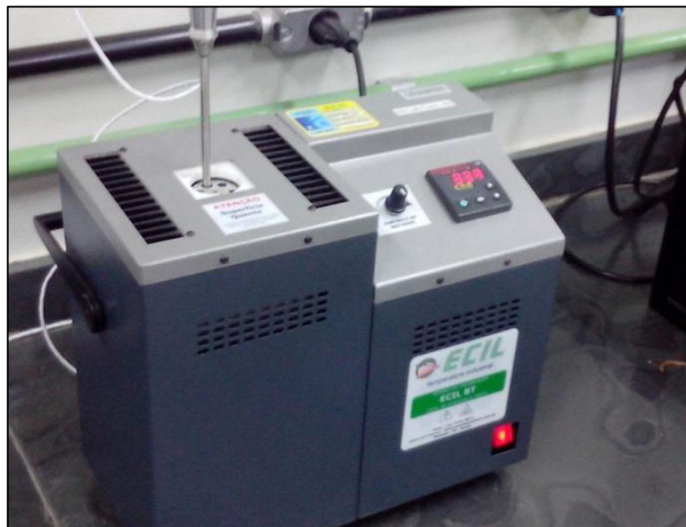
FIGURA 3.11 - Padrão utilizado para calibração dos sensores de temperatura
